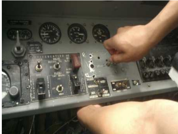
Figura 3.27: Adaptación del selector de temperatura
