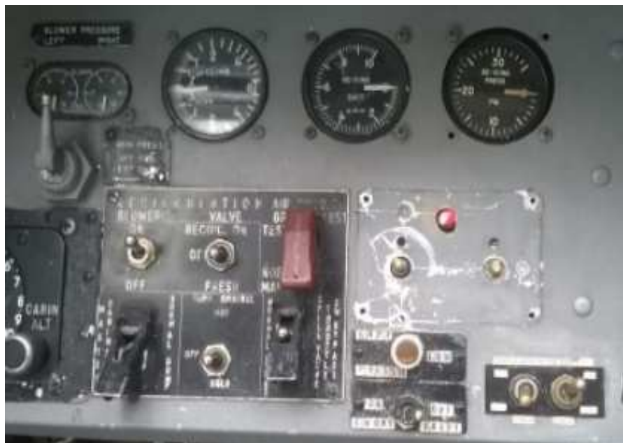
Figura 3.32: Ubicación de la luz piloto en el panel lateral
