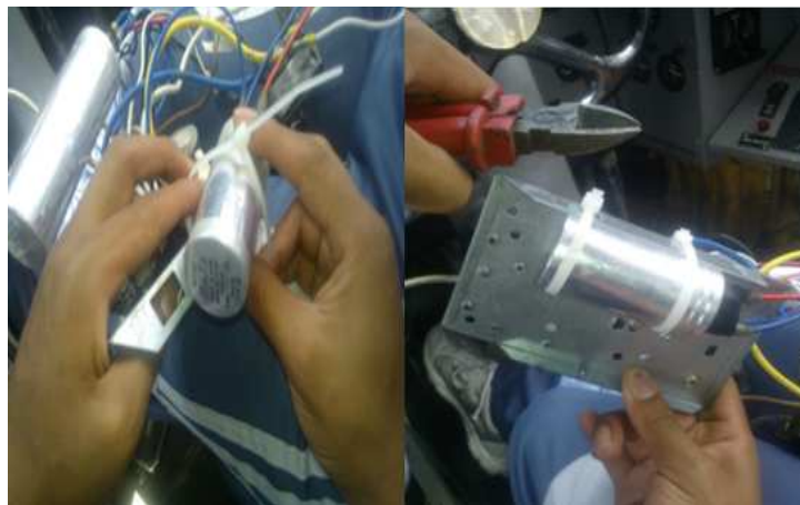
Figura 3.24: Montaje de los condensadores
