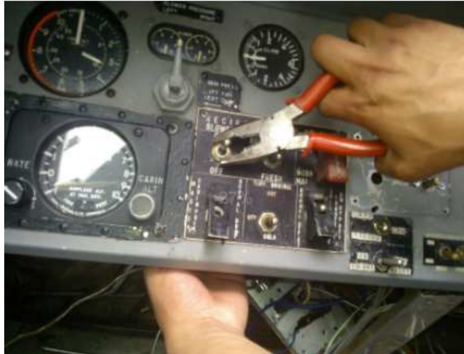
Figura 3.29: Adaptación del switch de posición ON-OFF
