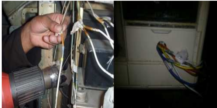
Figura 3.13: Uniones frías en la estación 655 del avión fairchild
