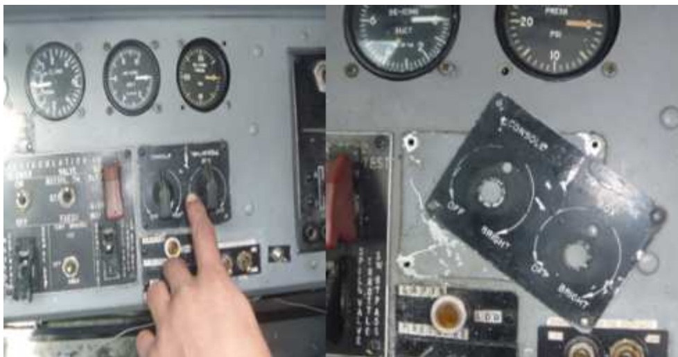
Figura 3.26: Remoción de la placa obsoleta
