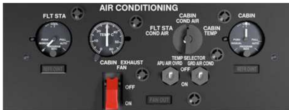
Figura 2.3: Control de la temperatura en cabina Fuente: CBT Airframe and powerplantmintage
