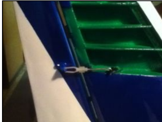
Figura 3. 18: Elevador vertical y rudder pintado
