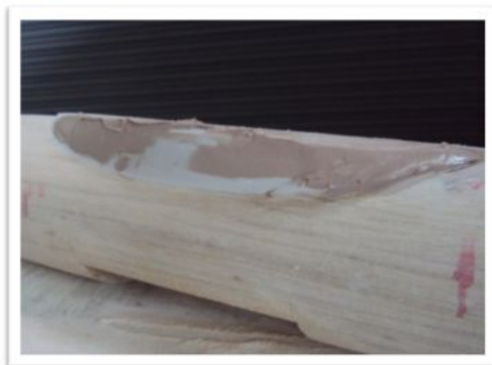
Figura 3.3: Colocación de la Macilla Carrenado
