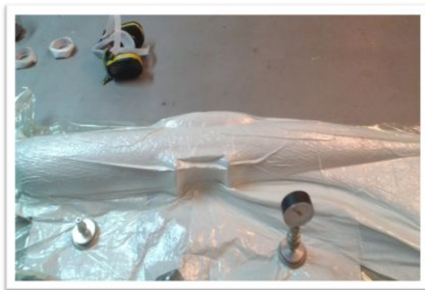
Figura 3.21: Proceso de Vacío Listo
