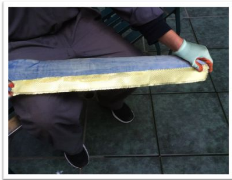
Figura 3.32: Laminado Kevlar en Borde de Ataque del Ala
