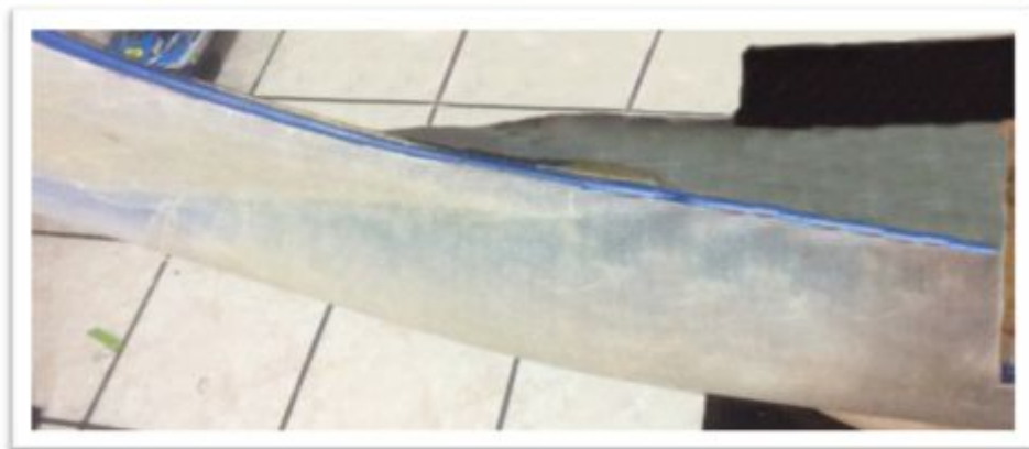
Figura 3.23: Separación del Molde Fuselaje
