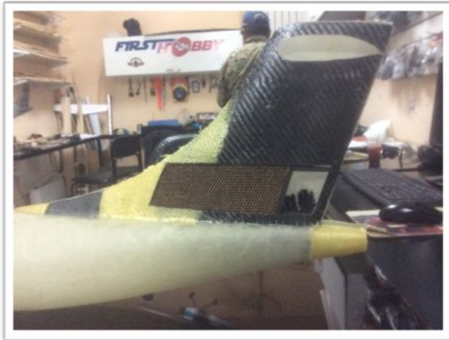
Figura 3.40: Estructura Nomex Estabilizador Vertical
