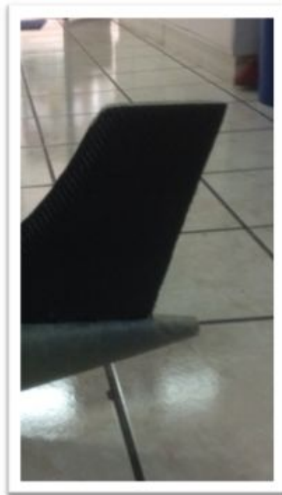
Figura 3.29: Laminado Carbono en Rudder
