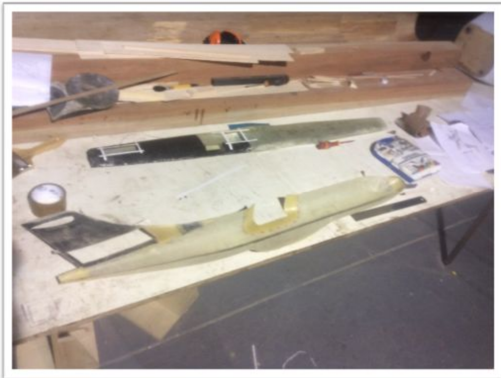
Figura 3.35: Seccionamiento de las superficies
