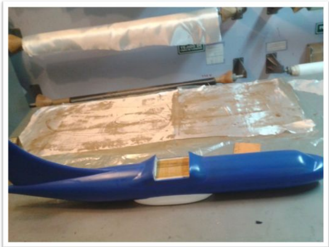
Figura 3.14: Aplicación del Desmoldante
