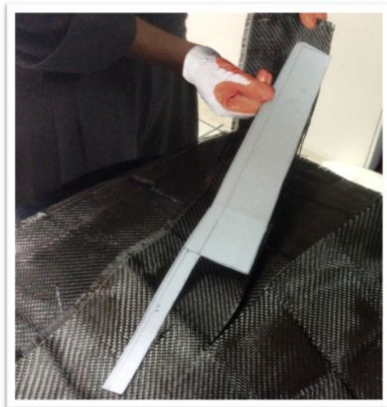
Figura 3.26. Cortado de la fibra de Carbono
