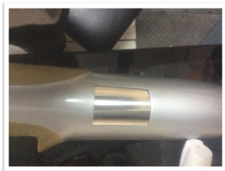
Figura 3.44: Lamiendo Fuselaje en aluminio
