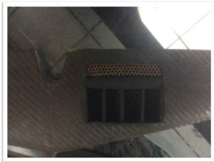
Figura 3.41: Estructura Nomex Estabilizador Horizontal
