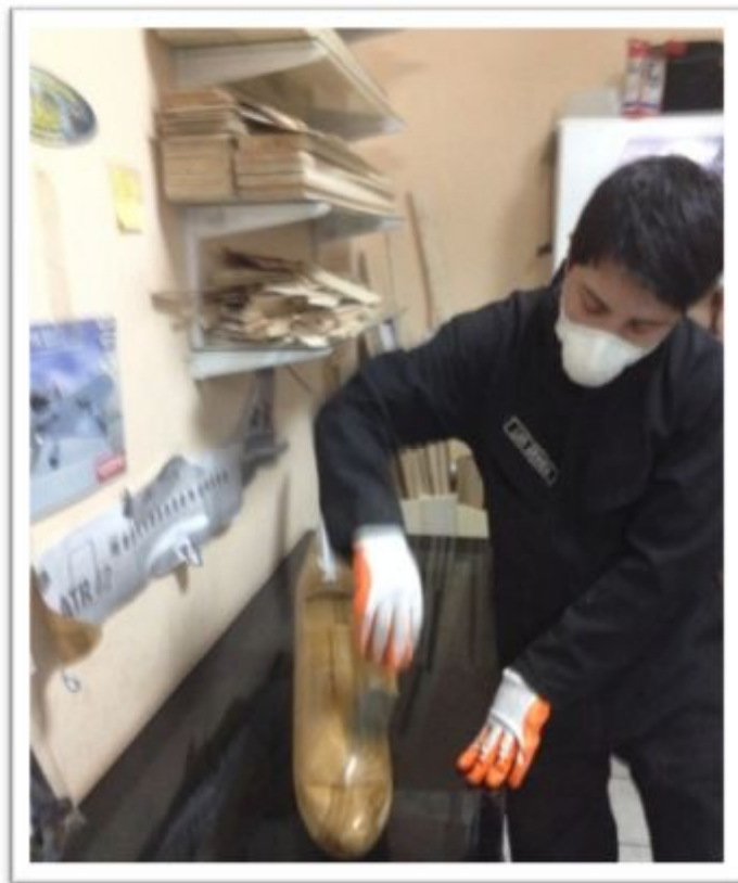
Figura 3.12: Aplicación del Sellador en los Moldes
