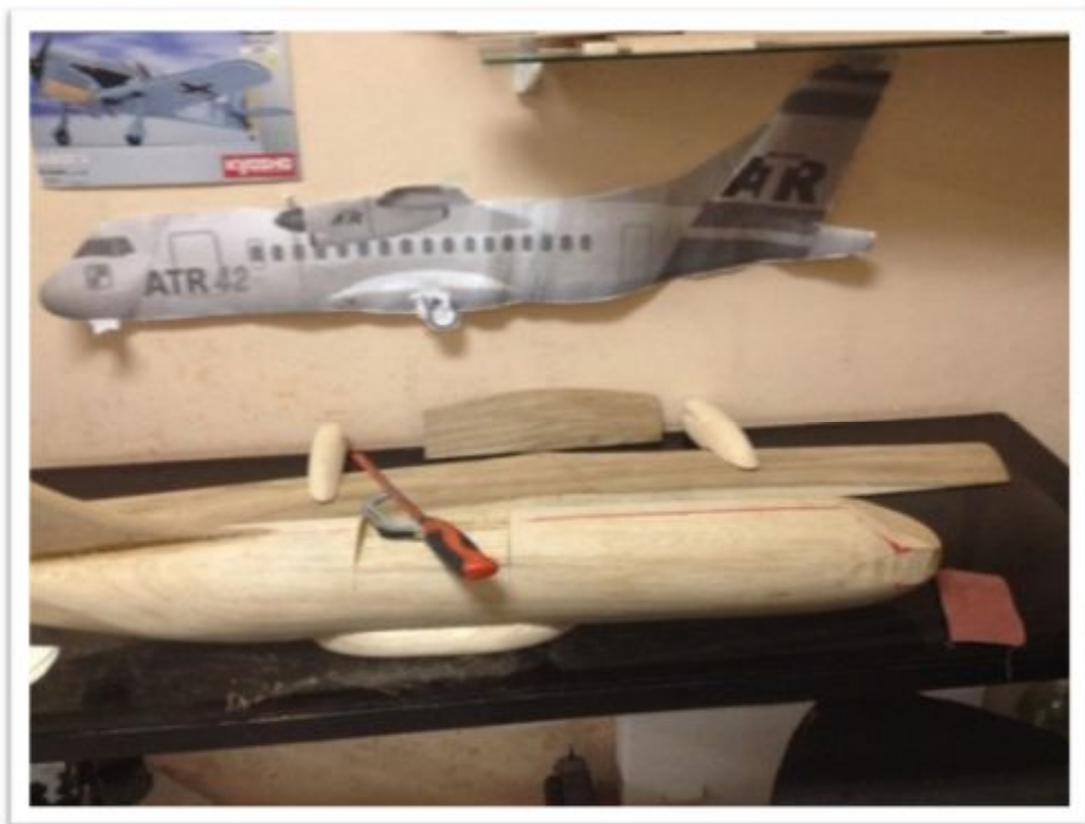
Figura 3.11: Lijado de las Superficies de los moldes
