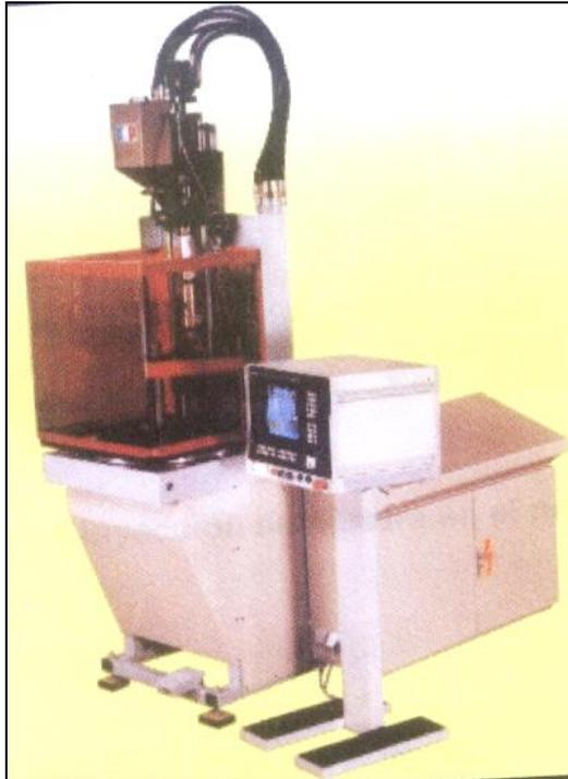
Figura 1.7. Inyección a baja presión para estampado y decoración en el molde
