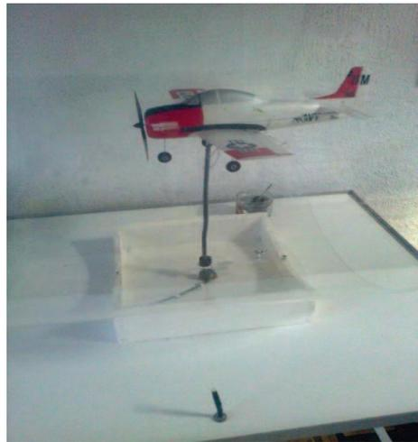
**Figura 3.23.** Eje de soporte del avión
