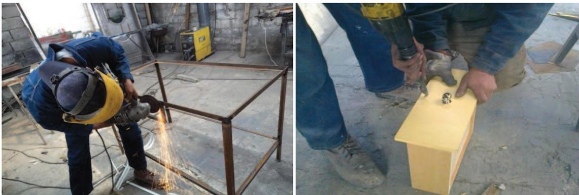
**Figura 3.25.** Pulido y acabado del cajón
