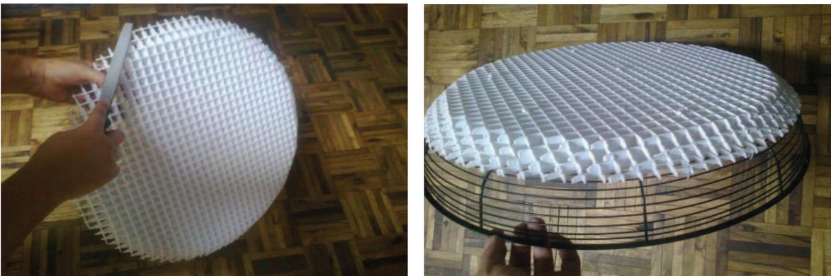
**Figura 3.19.** Lijado e instalación de las circunferencias
