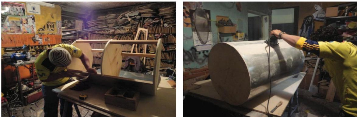
**Figura 3.12.** Armado y lijado del molde del cilindro de acrílico
