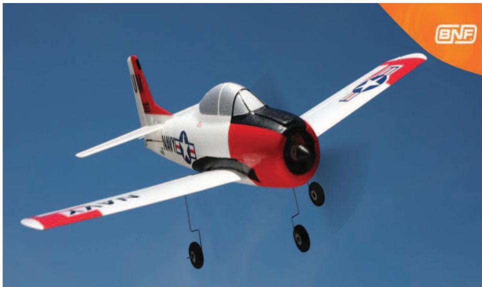
**Figura 3.1.** Avión a escala de poliestireno expandido
