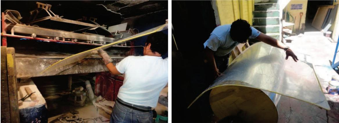
**Figura 3.13.** Armado del cilindro del acrílico
