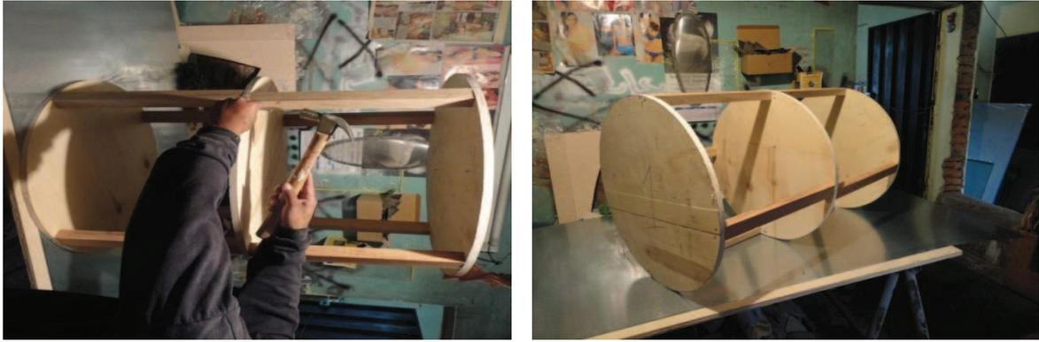
**Figura 3.11.** Armado de la estructura de madera y corte del tol
