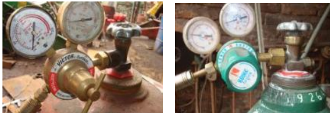
Figura 4.3. Calibración de Presiones OAW
