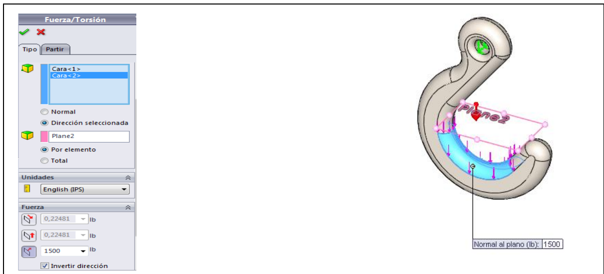
Figura 3.15. Cargas del Gancho de Grúa
