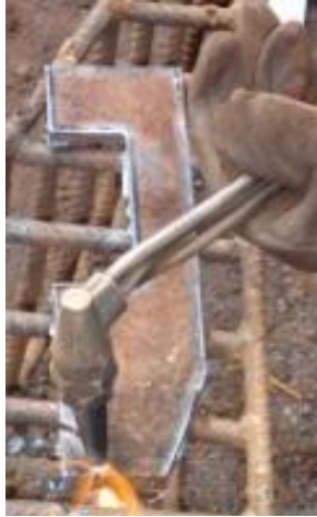
Figura 4.13. Proceso de oxicorte
