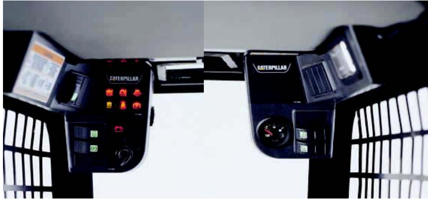
Figura 1.8. Tablero de instrumentos CAT
