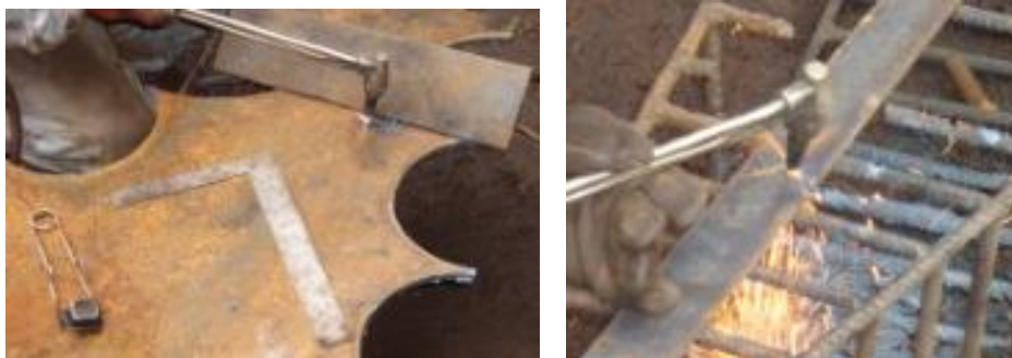
Figura 4.8. Proceso de oxicorte
