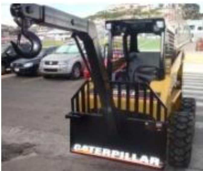
Figura 4.37.- Brazo para manejo de material acoplada a la minicargadora cat 226B
