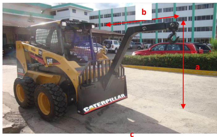
Figura 5.1.- Minicargadora cat 226B equipada con el brazo para manejo de material
