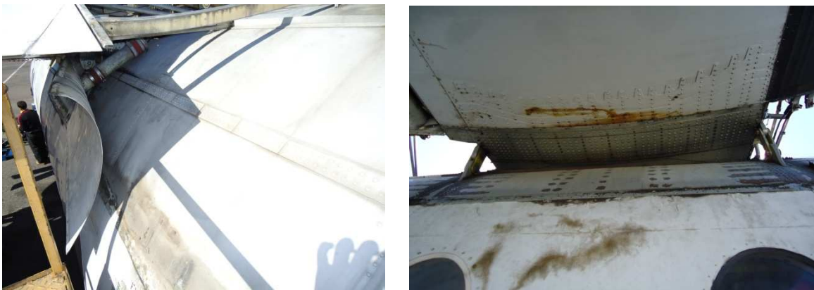
Figura 3.9: Desmontaje de la cubierta de la sección del ala central
