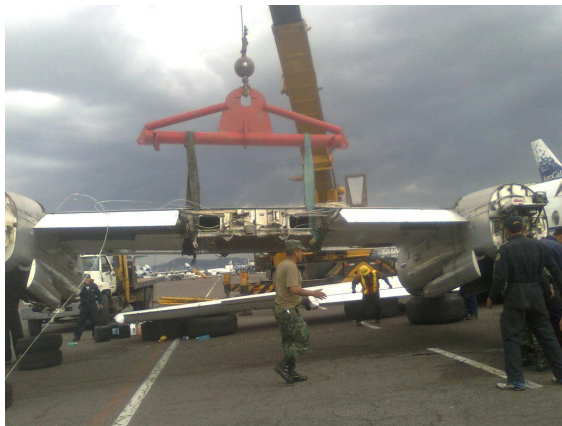
Figura 3.14: Desmontaje del ala central
