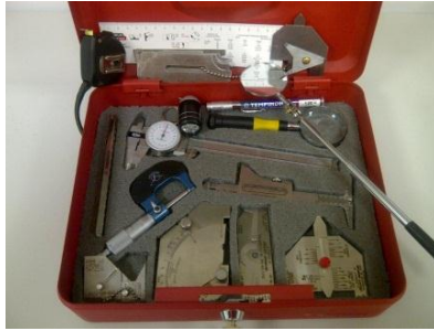
Figura 2.8 Instrumentos utilizados en inspección visual
