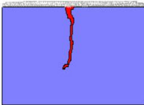
Figura 3.10 Aplicación del revelador
