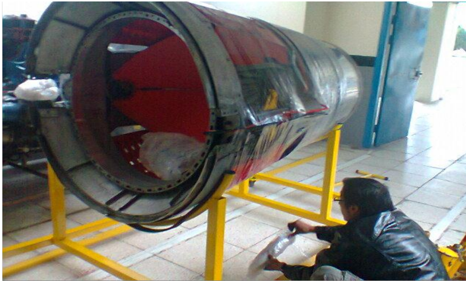
Figura 3.26. Instalación de la reversa en su soporte
