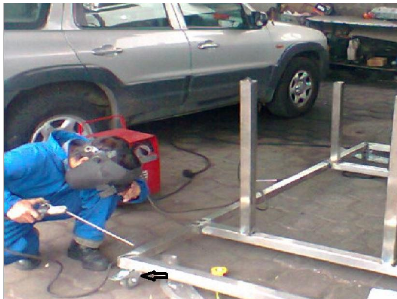
Figura 3.22. Instalación de garruchas
