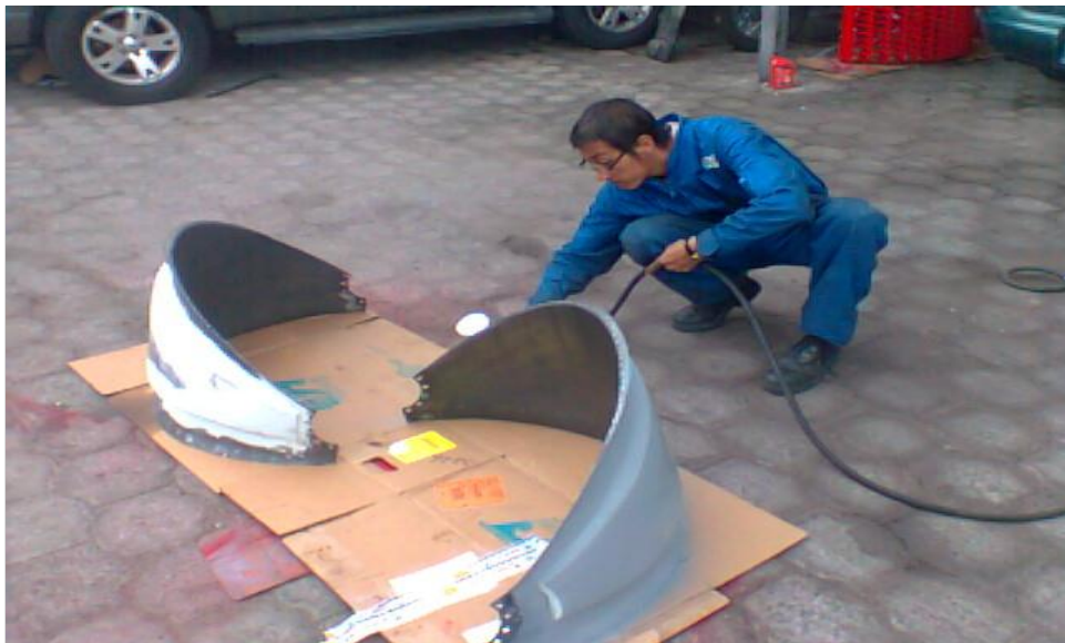
Figura 3.15. Acabado, limpieza y pintura
