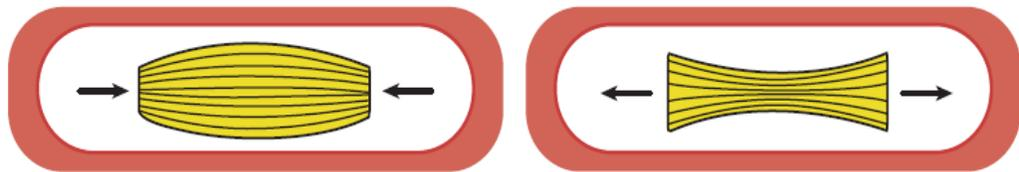
*Nota.* Representa las cargas compresivas y cargas en tracción y cómo actúan los materiales compuestos. Tomado de *Materiales y materias primas* (p. 8) por, Stupenengo, F., 2011, Inet.
