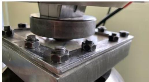
*Nota.* Es importante apoyar las mordazas cerradas correctamente sobre la placa plana para garantizar que se aplica la fuerza sobre el centro de la probeta.
