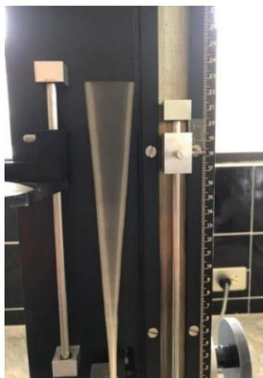
En cada probeta se realizó este procedimiento 5 veces para así obtener al final un promedio de cada una de las longitudes en donde se presentaba el primer modo de vibración, a continuación se presentan los datos adquiridos en este ensayo en la Tabla 7.
