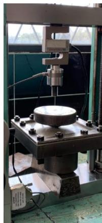
Es importante resaltar que el eje que se encuentra en la celda de carga se apoye en el centro de la parte plana del accesorio semiesférico y este a su vez se encuentre alineado con el centro de la probeta. Una vez garantizadas estas consideraciones se procede a aplicar la carga concentrada a través del panel de control que se puede observar en la Figura 71.
