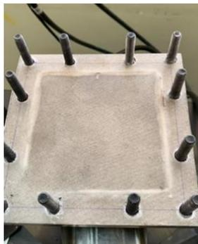
*Nota.* En la esquina inferior izquierda se observa que no se presenta la decoloración de la probeta, indicando que la carga no se aplica uniformemente.
