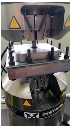
*Nota.* Para proteger en este caso la probeta de material compuesto, se puso entre el material y la placa, una capa de neopreno del mismo tamaño que el área efectiva.
