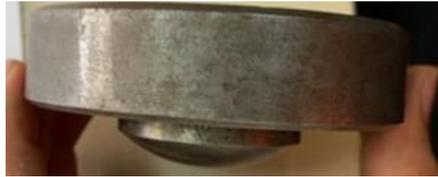
Los pasos a seguir dentro de este ensayo comienzan con poner tanto el accesorio inferior al que va sujeta la probeta de material compuesto en contacto con el accesorio semiesférico, esto se logra a través del eje que se encuentra instalado en la celda de carga de la máquina tal como se observa en la Figura 70.
