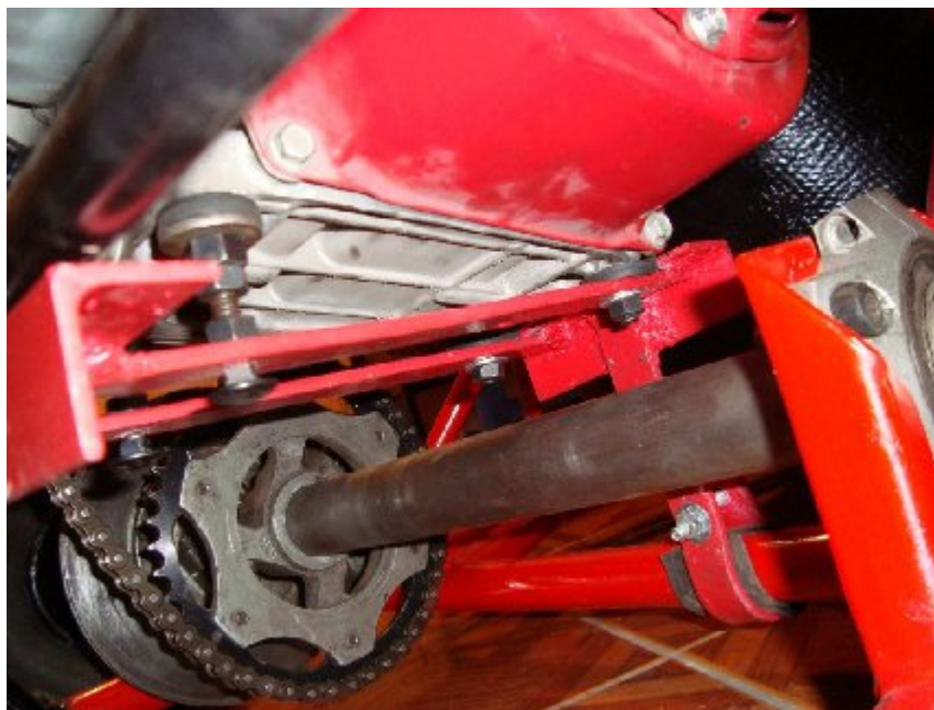
Figura 4.18. Ensamblaje soporte motor
