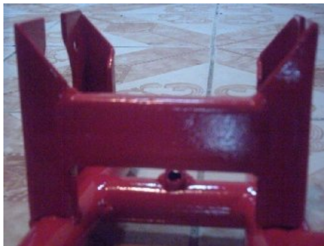
Figura 4.13. Sujetador del soporte eje posterior
