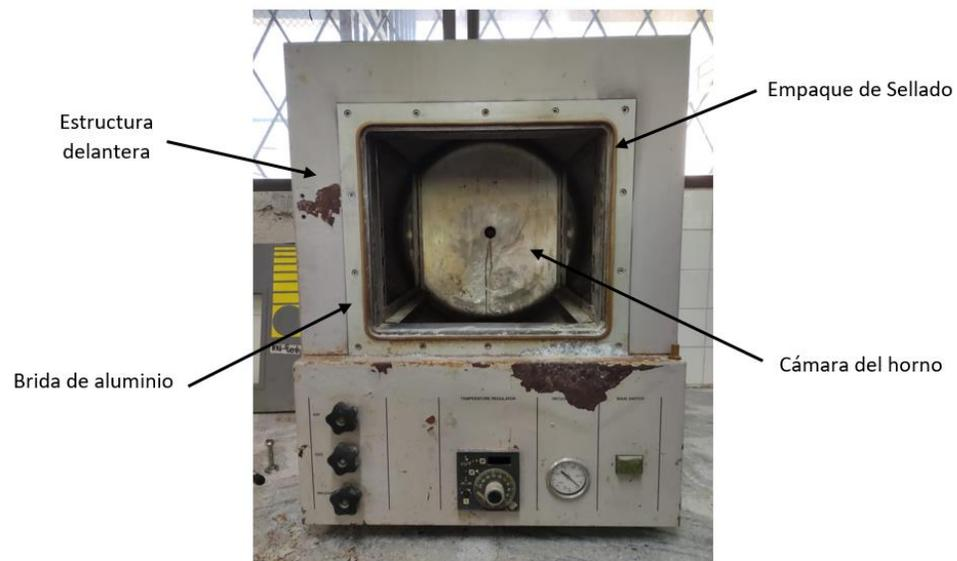
En la Figura 8 se muestra la identificación de los componentes visibles en la vista trasera del equipo.
