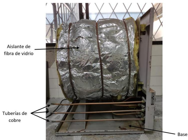
En la Figura 10 se muestra la identificación de los componentes dispuestos en el tanque.
