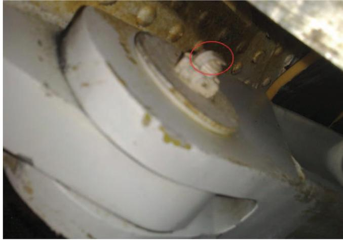
**Figura 3.41: Posición del cotter pin o pasador**
