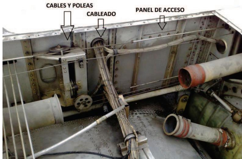
**Figura 3.14: Ductos desconectados**
