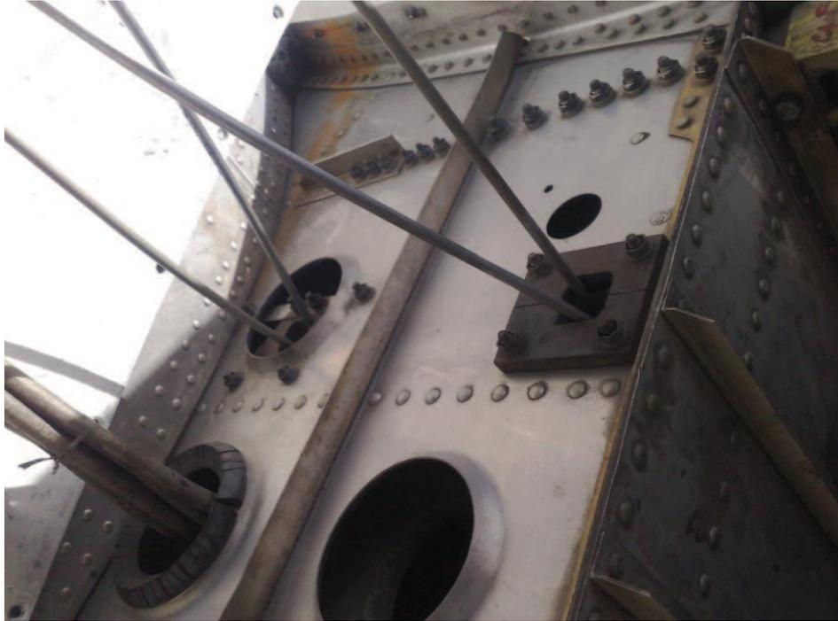
**Figura 3.25: Cables rudder y elevadores parte exterior**
