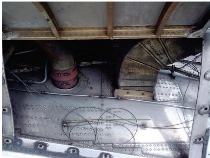
**Figura 3.28: Cables tensión liberada rudder y elevadores**
