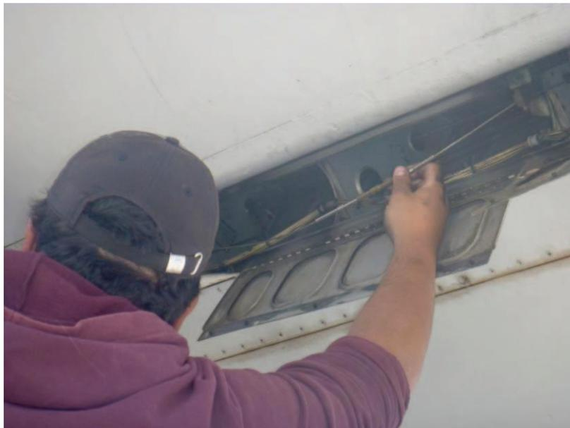
**Figura 3.24: Turnbuckles alerón izquierdo desconexión**
