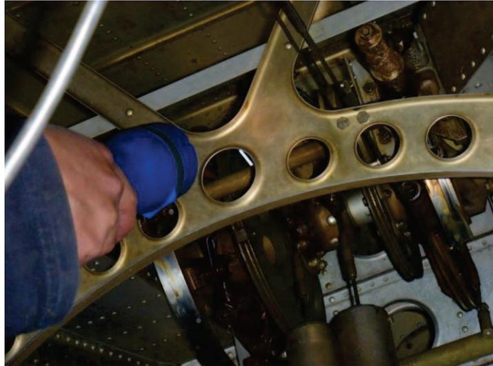
**Figura 3.27: Turnbuckles rudder y elevadores compartimiento interior**
