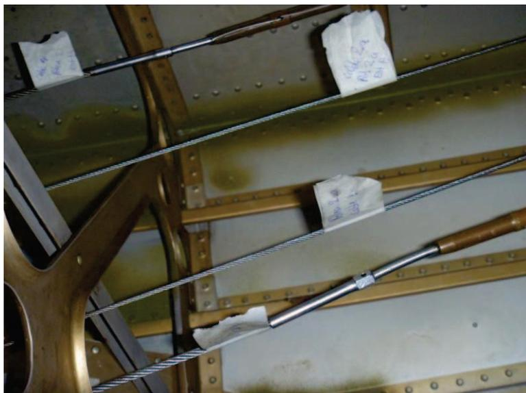
**Figura 3.32: Señalización cables rudder y elevador compartimiento interior**
