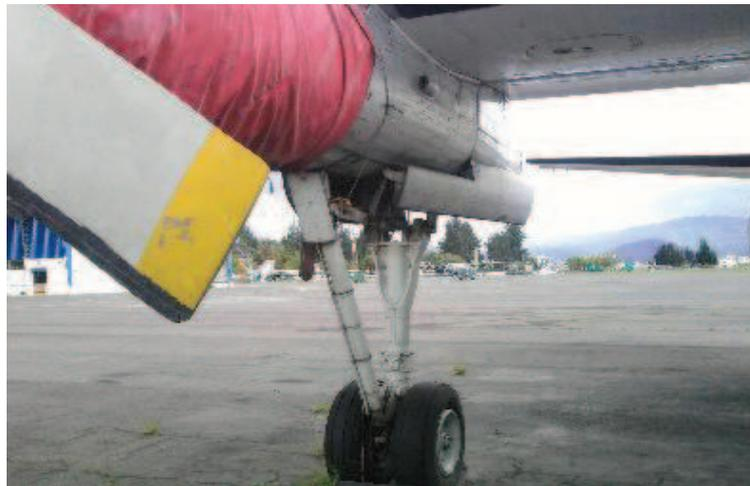
**Figura 3.3 Compartimento del tren de aterrizaje del FH-227**
