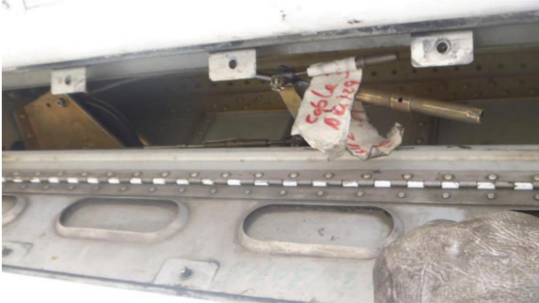
**Figura 3.33: Señalización en cables de alerón y compensador**
