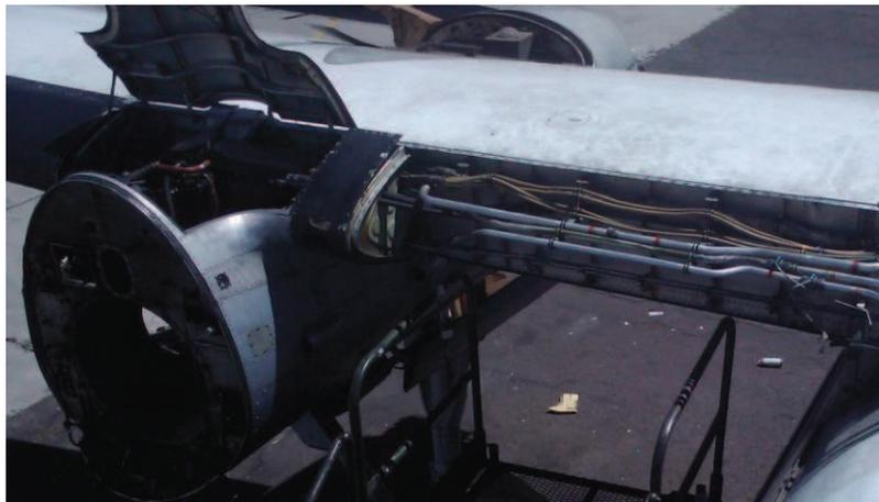
**Figura 3.8: Borde de ataque derecho ala central removido**
