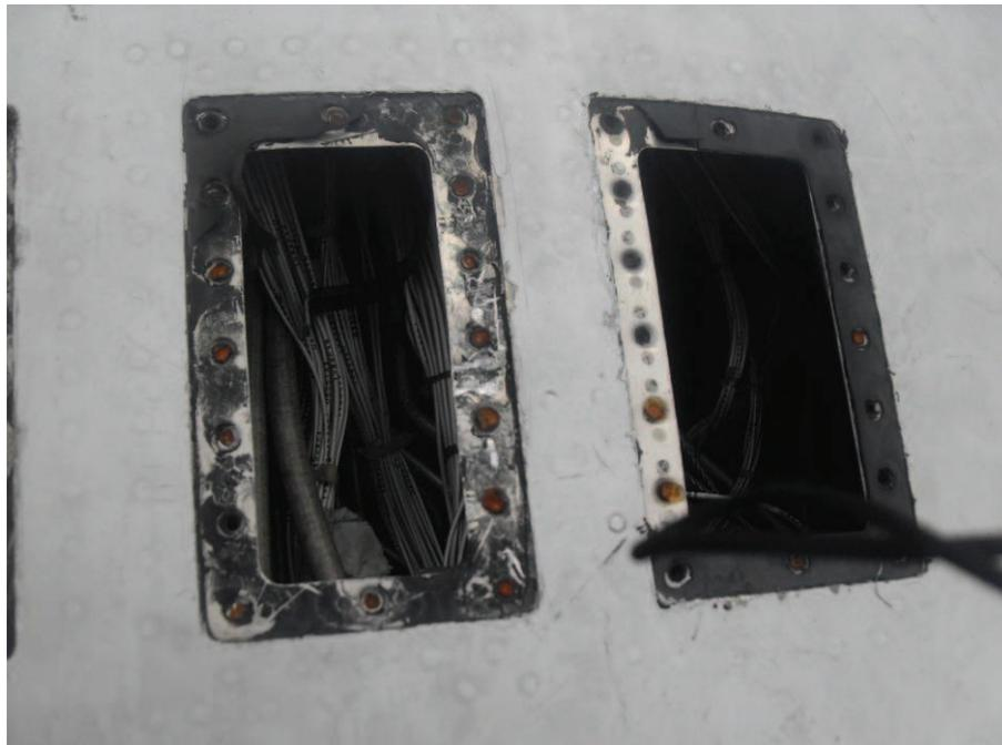
**Figura 3.16: Paneles de acceso a conectores**
