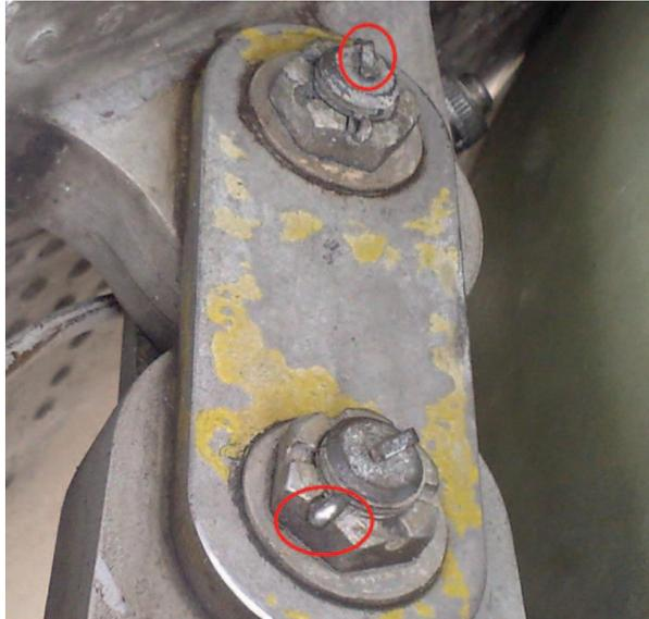
**Figura 3.46: Posición del cotter pin o pasador**
