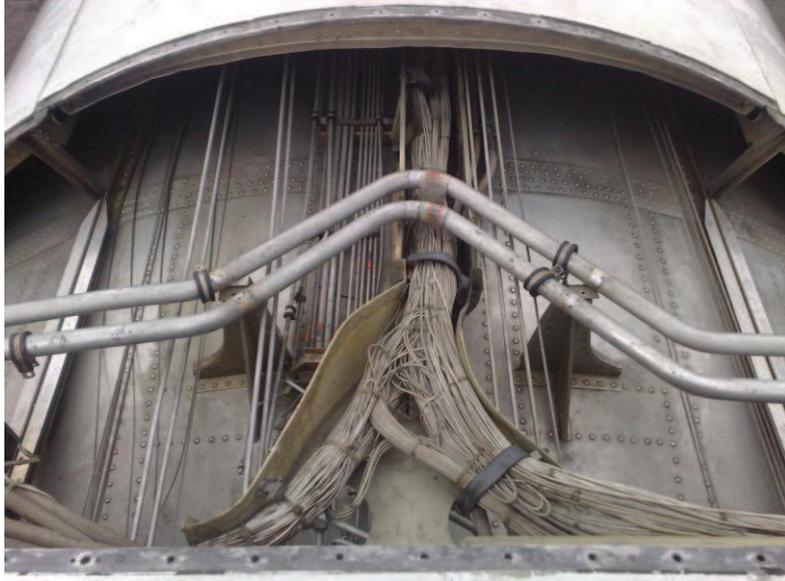
**Figura 3.9: Remoción de carenajes parte delantera ala central**
