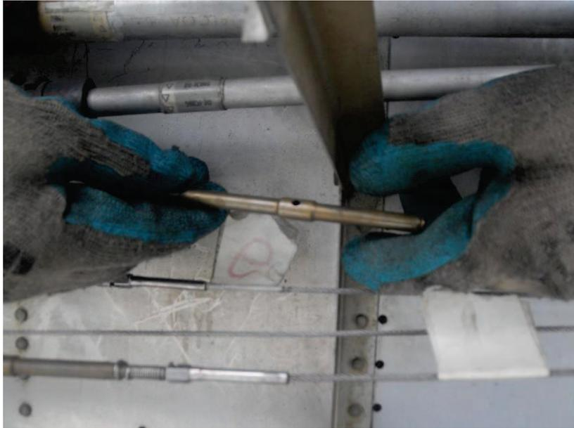
**Figura 3.23: Turnbuckles desconexión**
