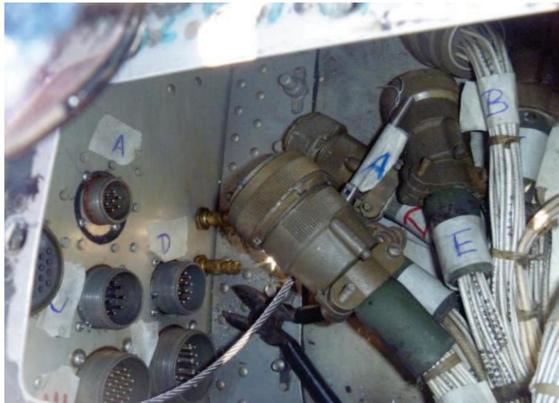
**Figura 3.18: Conectores macho, hembra y señalización**
