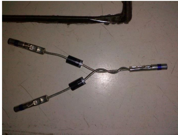
Figura 3.12: Compuerta OR formada con Diodos
