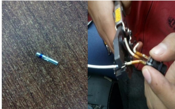
Figura 3.8: Uniones frías y Remachadora
