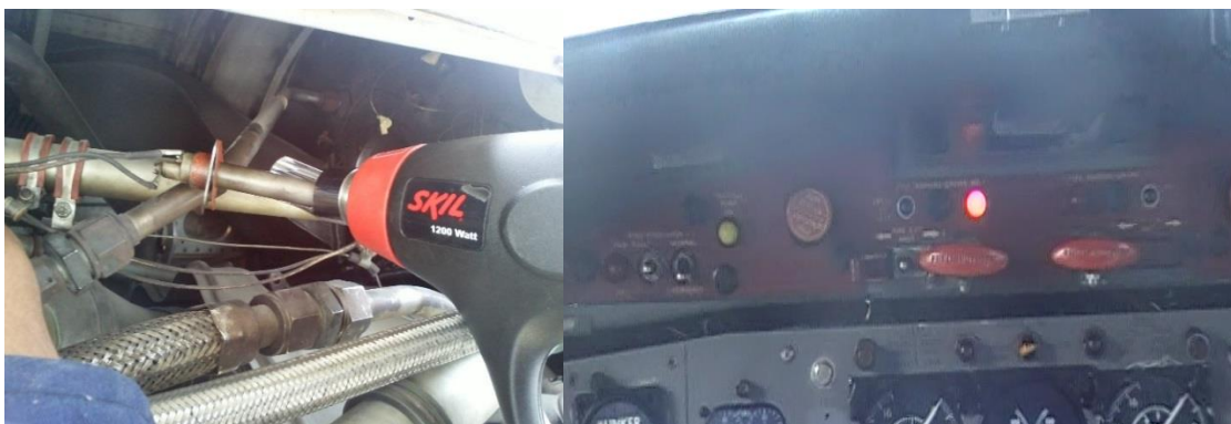
Figura 3.30: Accionamiento del termo switch con pistola de calor.
