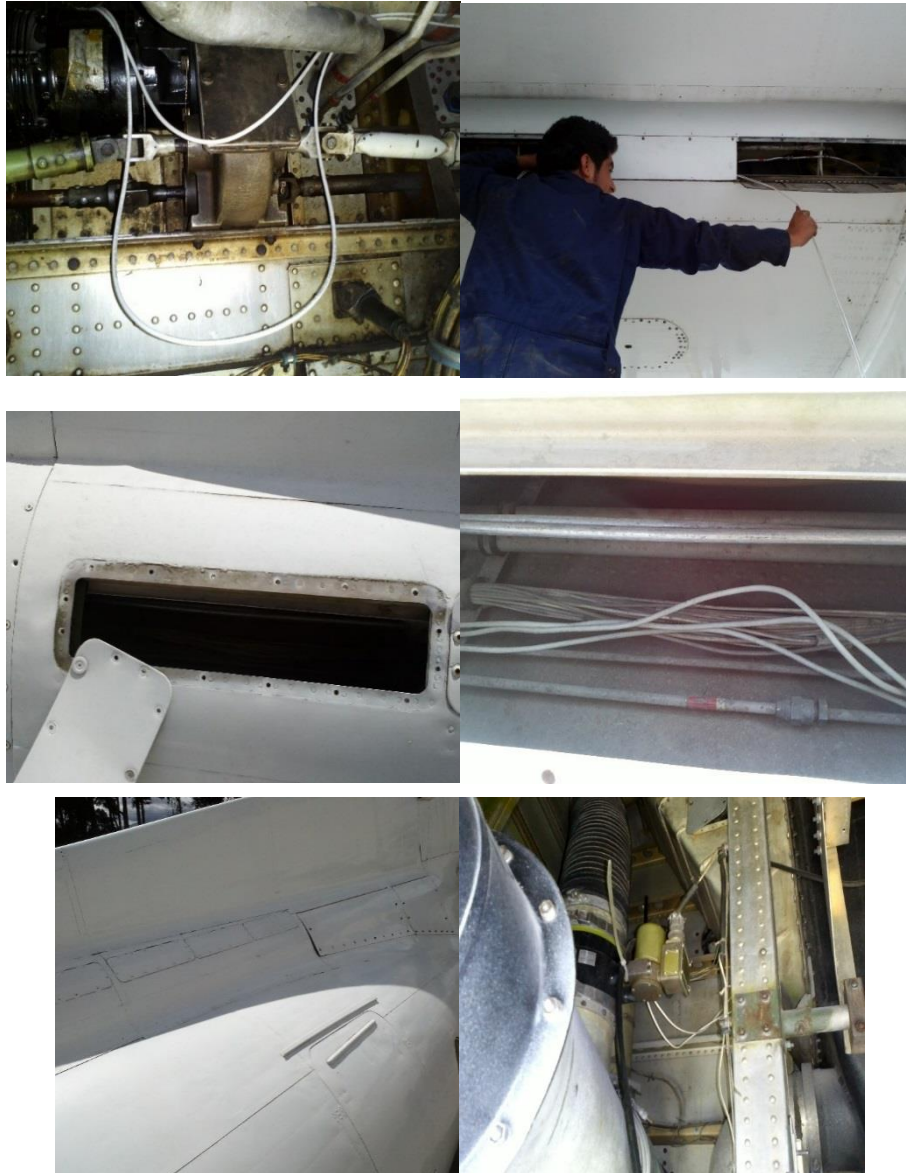
Figura 3.16: Compartimientos y bahías secas por donde se envió los cables.
