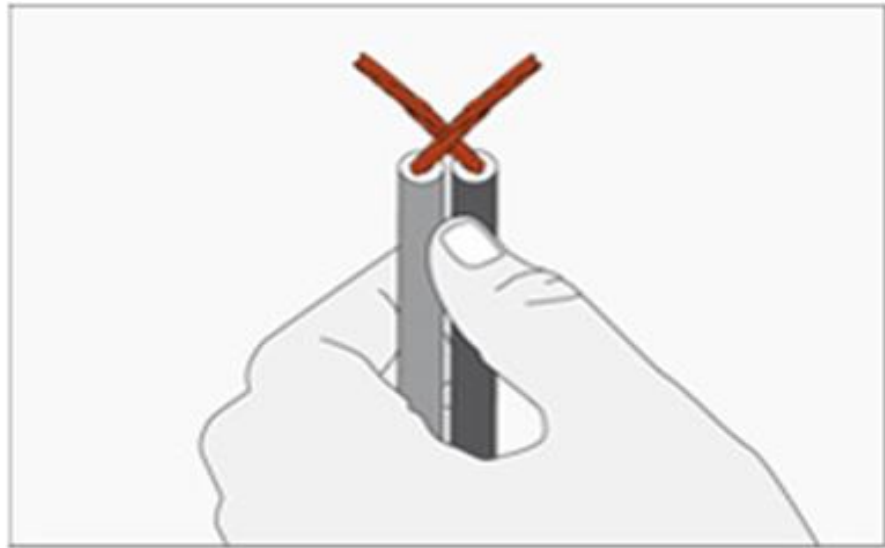
Figura 2.20: Empalme en dirección opuesta.
