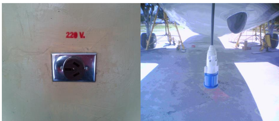
Figura 3.15: Fuente de poder del avión Fairchild FH-227
