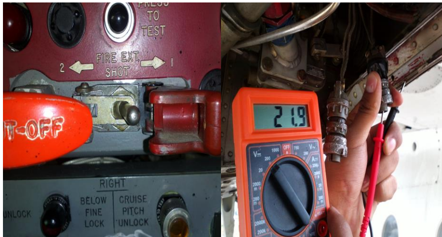
Figura 3.27: Continuidad eléctrica de los plugs extintores N°1
