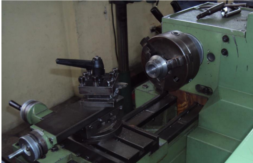
Figura3.37: Torneado de las bases, acero de 2 ½”
