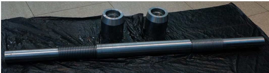
Figura 3.22: Eje con sus tuercas de seguridad
