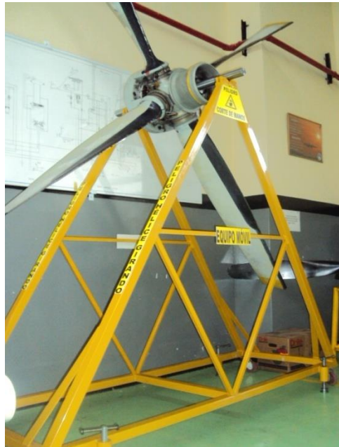
Figura 3.49: Banco móvil de pruebas para el balance estático y tracking
