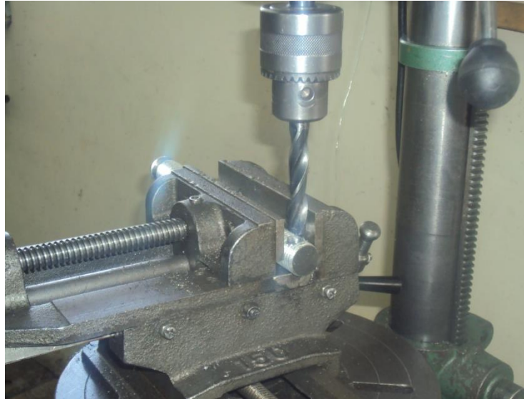
Figura3.33: Perforación en la parte superior del eje
