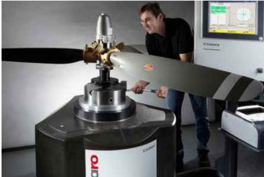
Figura 2.28: Equipo para calibrar flojedad de palas y cubo.
