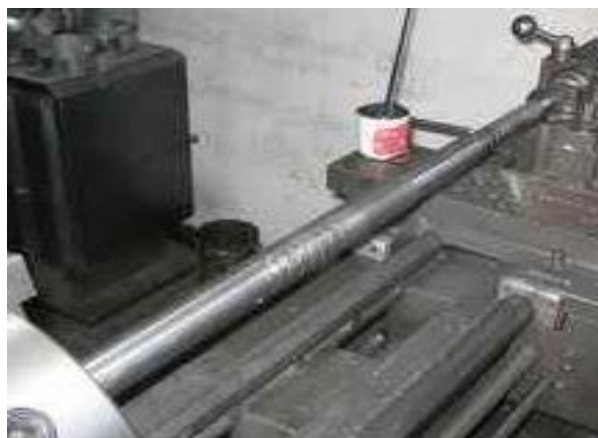
Figura 3.12: Montaje del eje
