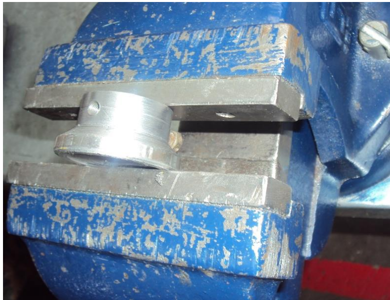
Figura3.38: Orificios para acopar base-tornillo
