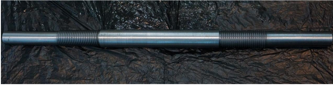
Figura 3.19: Fin de la elaboración del eje (desbaste-roscado)
