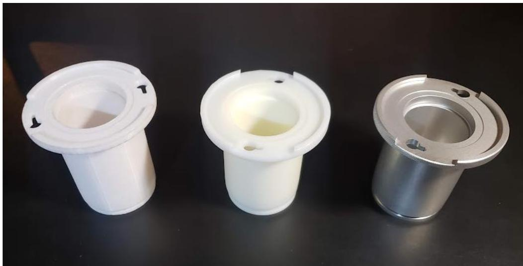
Nota: De izquierda a derecha se tiene: Prototipo exploratorio, prototipo funcional y prototipo operativo.
