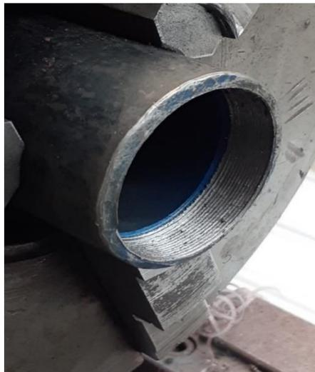
Nota: Tubo roscado para sujeción de tapa al mandril del torno.
