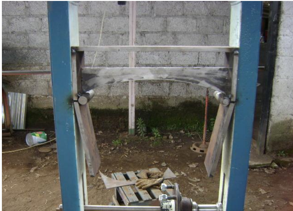
Fig 5.11 Construcción del mecanismo para aplicación de la fuerza
