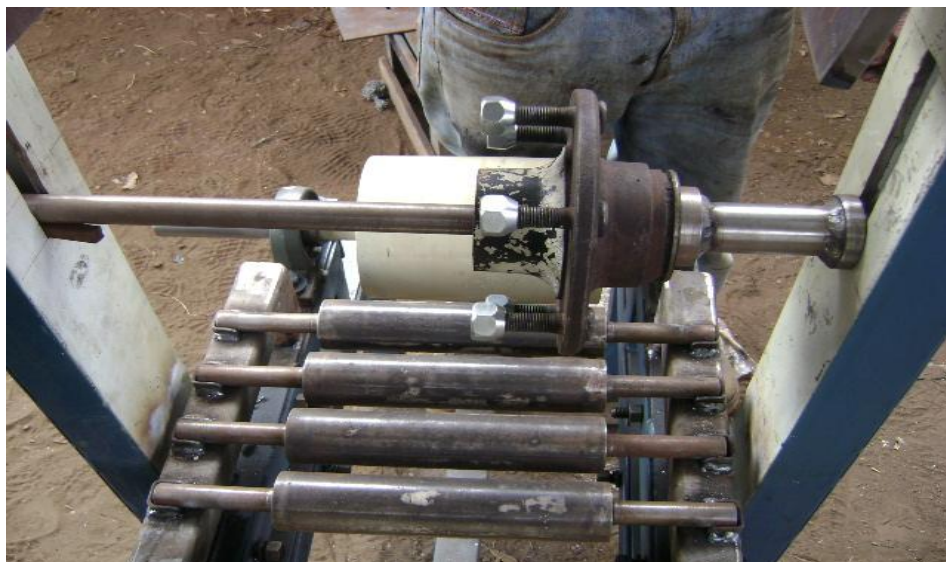
Fig 5.9 Montaje de los rodillos en el sistema de rodadura
