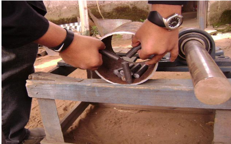
Fig 5.8 Construcción del sistema de rodadura
