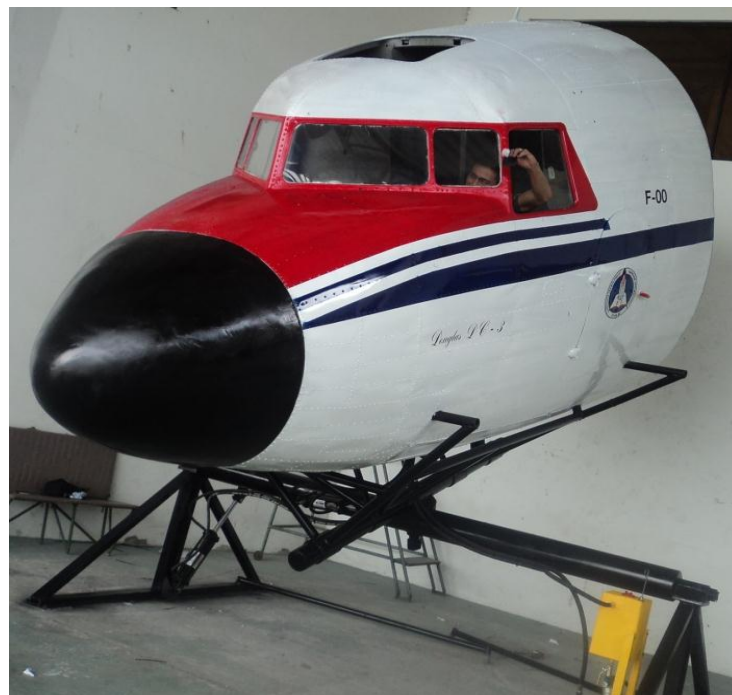
Figura 3. 17: Prueba de funcionamiento de alabeo
