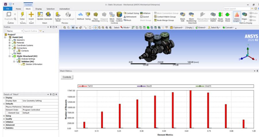
*Nota.* Con la métrica que ofrece el software, se puede observar que la calidad del mallado es deficiente.
