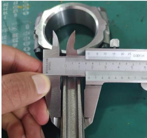
*Nota.* Obtención de la medida del cuerpo de biela con el calibrador.
