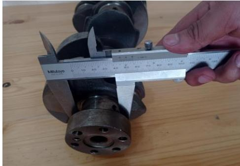
*Nota.* Obtención del diámetro del codo de bancada del cigüeñal.
