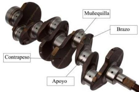
*Nota.* Adaptado de *Desarrollo de un modelo de deformaciones del mecanismo pistón-biela-manivela de un motor alternativo* (p.15), por M. Rueda, 2017, Universidad Politécnica de Valencia.
