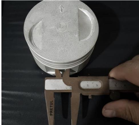
*Nota.* Obtención de la medida del orificio del bulón, con la utilización de un calibrador pie de rey.
