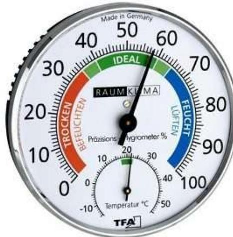
*Nota.* En la figura se muestra un higrómetro de la marca Alemana TFA. Tomado de (Airlia, 2021)
