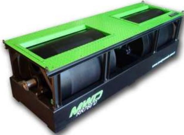
*Nota.* En la figura se muestra la disposición de los rodillos dentro del chasis del dinamómetro de inercia. Tomado de (Amarilla, 2016)
