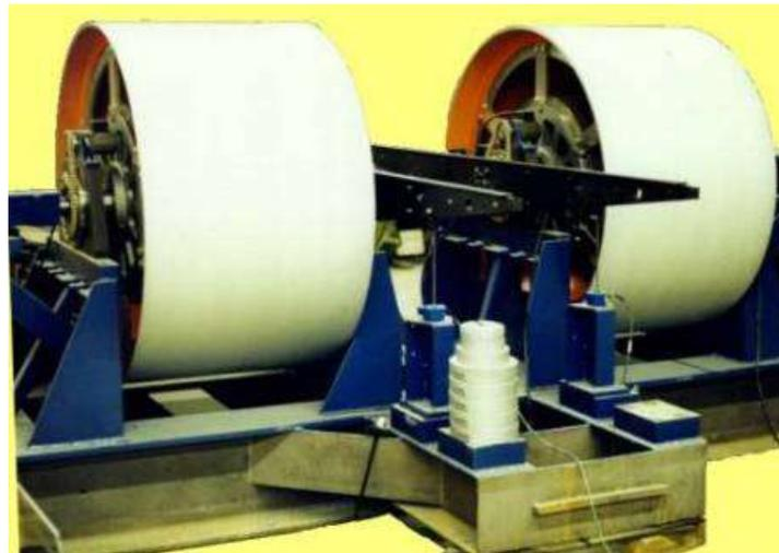
*Nota.* La figura muestra un par de rodillos que se utilizan en un dinamómetro. Tomado de (Hernández, 2007)
