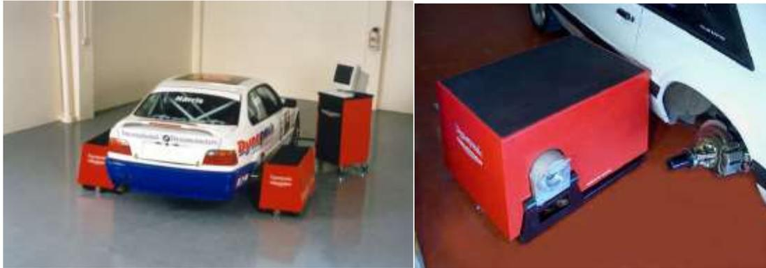
*Nota.* En la figura se aprecia un dinamómetro de freno o carga sin rodillos, donde su acoplamiento es directo al tambor o disco del vehículo. Tomado de (Hernández, 2007)
