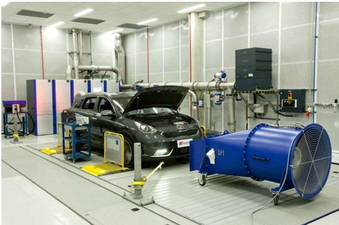
*Nota.* En la figura se observa un vehículo siendo sometido a pruebas sobre un dinamómetro de rodillos con todas las medidas de seguridad e implementos correspondientes. Tomado de (PWS, 2019)
