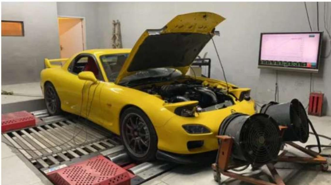
*Nota.* La figura demuestra la funcionalidad de los ventiladores durante el uso del dinamómetro. Tomado de (Yang, 2019)
