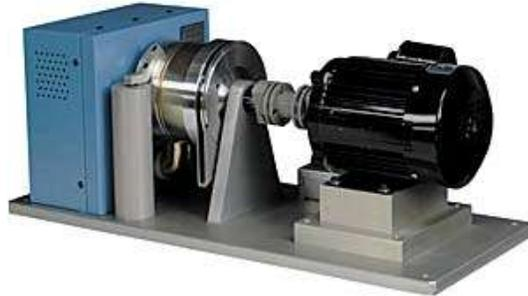
*Nota.* En la figura se observa un dinamómetro de motor aplicado como un medidor de torque. Tomado de (Hernández, 2007)
