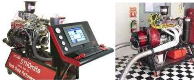
*Nota.* La figura representa un motor de combustión interna empotrado sobre un dinamómetro de motor para su posterior prueba. Tomado de (Hernández, 2007)
