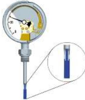
*Nota.* En la imagen se muestra un termómetro de dilatación de gas. Tomado de (Cartie, 2014)
