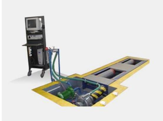
*Nota.* La figura representa la conexión de la computadora al dinamómetro para posteriormente procesar los datos obtenidos. Tomado de (Montes, 2016).
