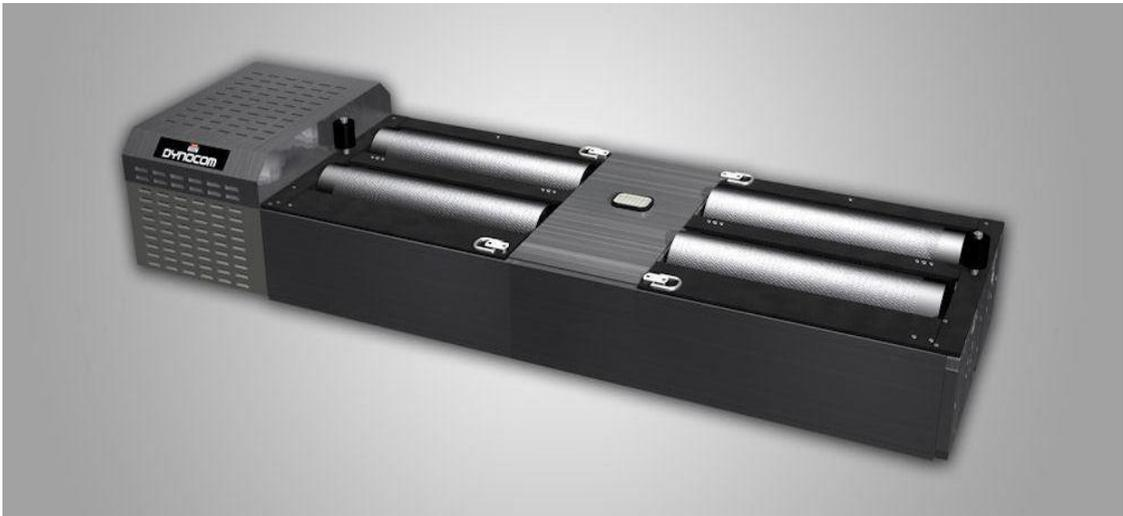
*Nota.* En la figura se observa que en este caso el freno del dinamómetro no se encuentra directamente acoplado al eje del cigüeñal de motor, sino de manera axial a uno de los rodillos del banco. Tomado de (Dynocom, 2021).
