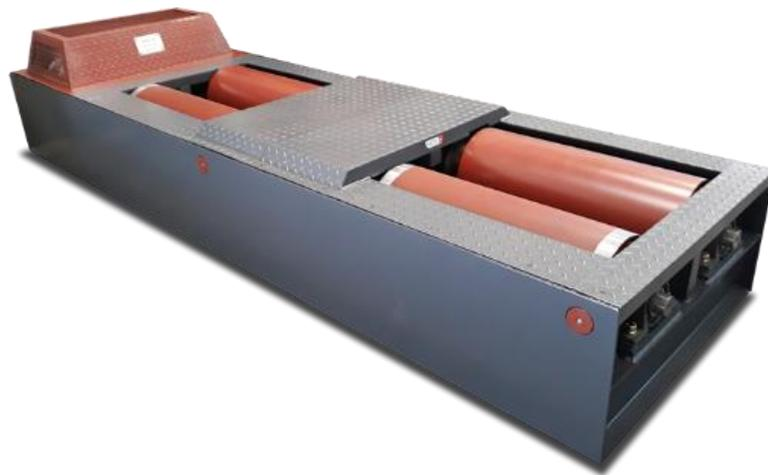
*Nota.* En la figura se observa un ejemplo de dinamómetro de cuatro rodillos el cual será empotrado al piso. Tomado de (Montes, 2016).
