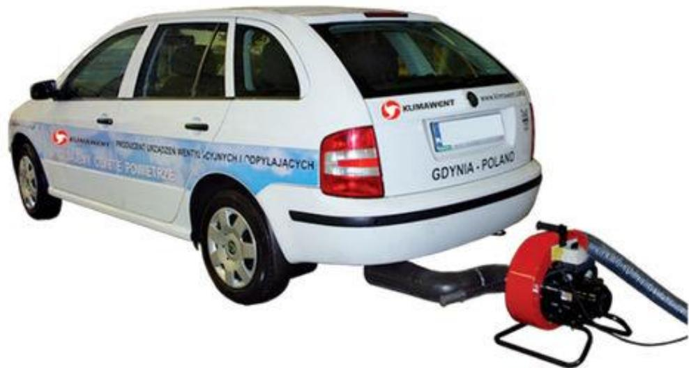
*Nota.* En la figura se observa la extracción de los gases de escape producidos al momento de realizar la prueba. Tomado de (Klimawent, 2021).
