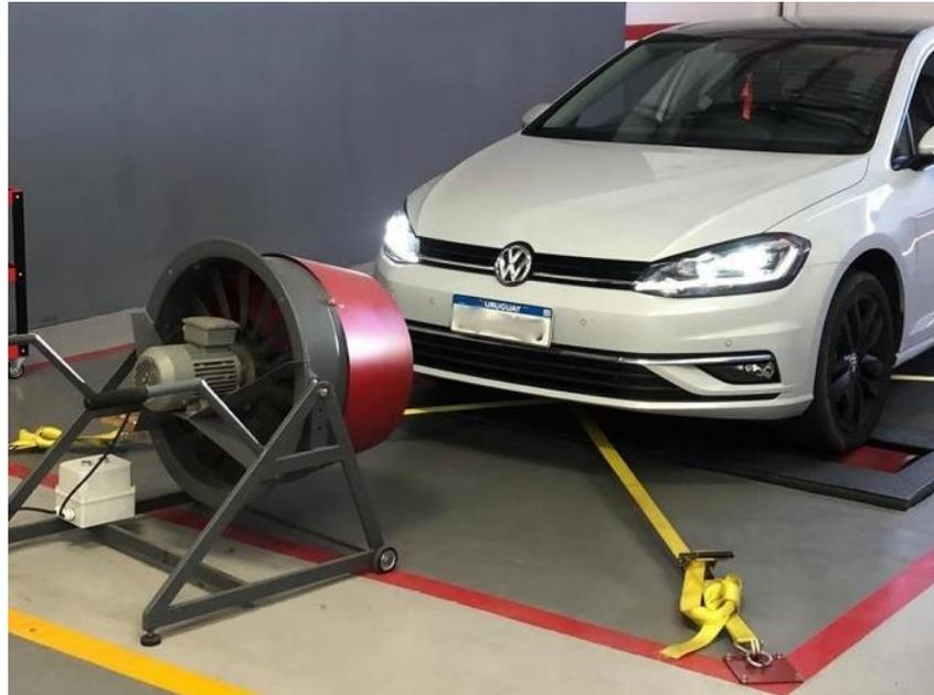
*Nota.* Sistema de ventilación se encuentra ubicado en la parte frontal para realizar la prueba con el dinamómetro. Tomado de (Montes, 2016).
