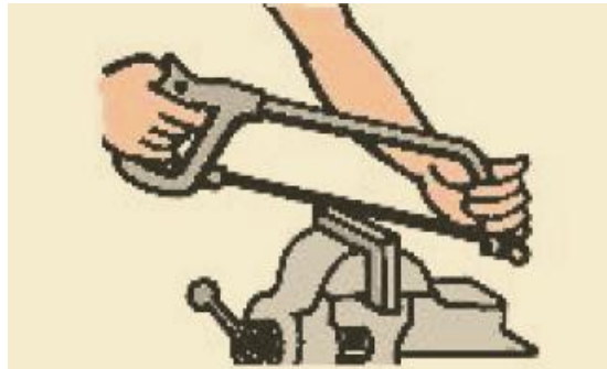
Figura 2.21. Pieza fijada firmemente antes de serrar
