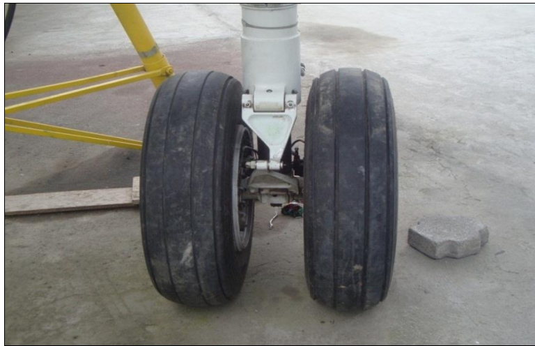
Figura 2. 2. Tren Principal del avión Fairchild FH 227J
