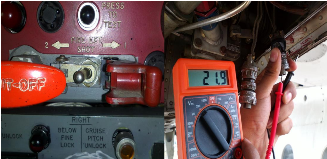
Figura 3.27: Continuidad eléctrica de los plugs extintores N°2
