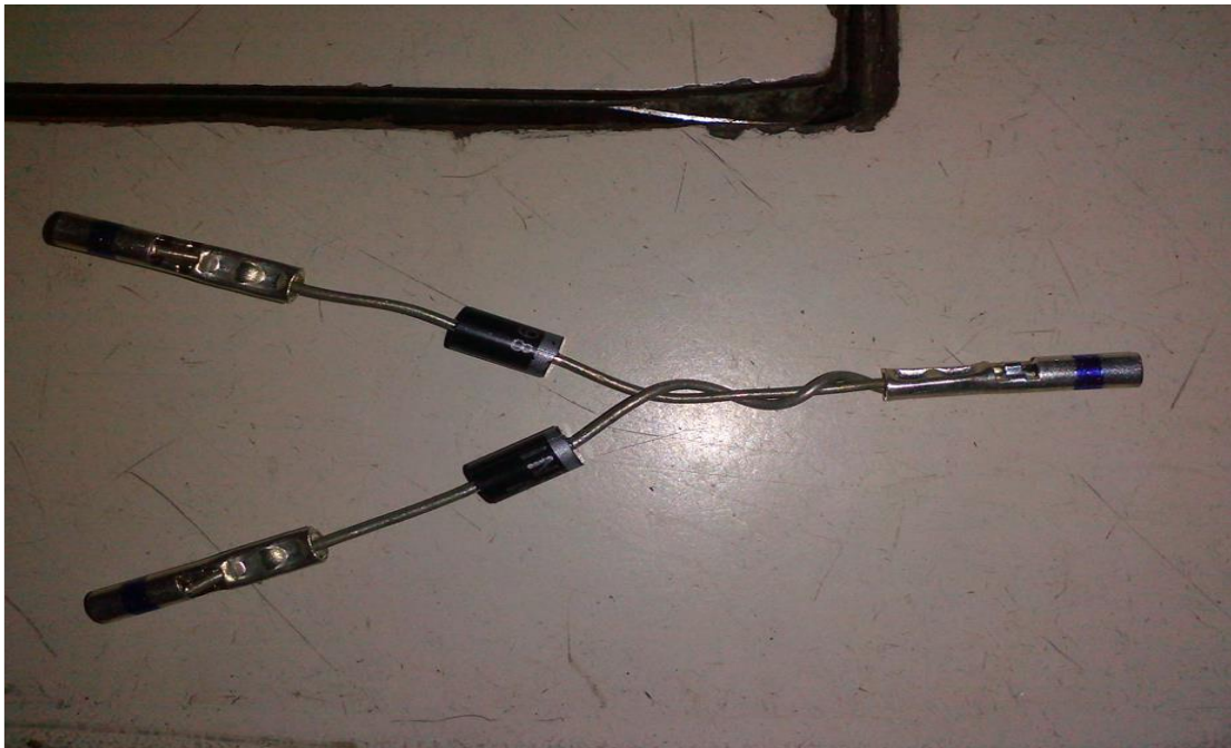
Figura 3.10: Compuerta OR con diodos
