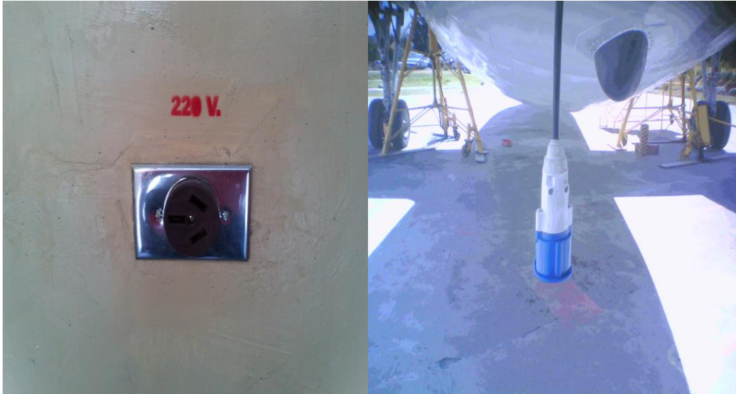
Figura 3.14: Fuente de poder del avión Fairchild FH-227
