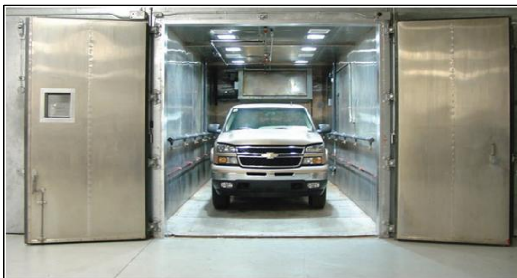
Figura 4.10.- Cámara SHED para medición de emisiones evaporativas.
