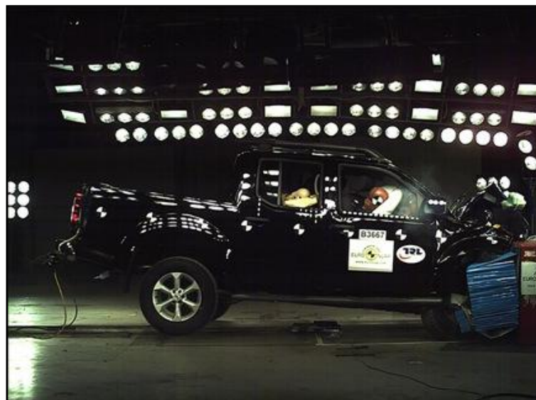
Figura 3.32.- Ensayo de impacto frontal, Nissan Navara.
