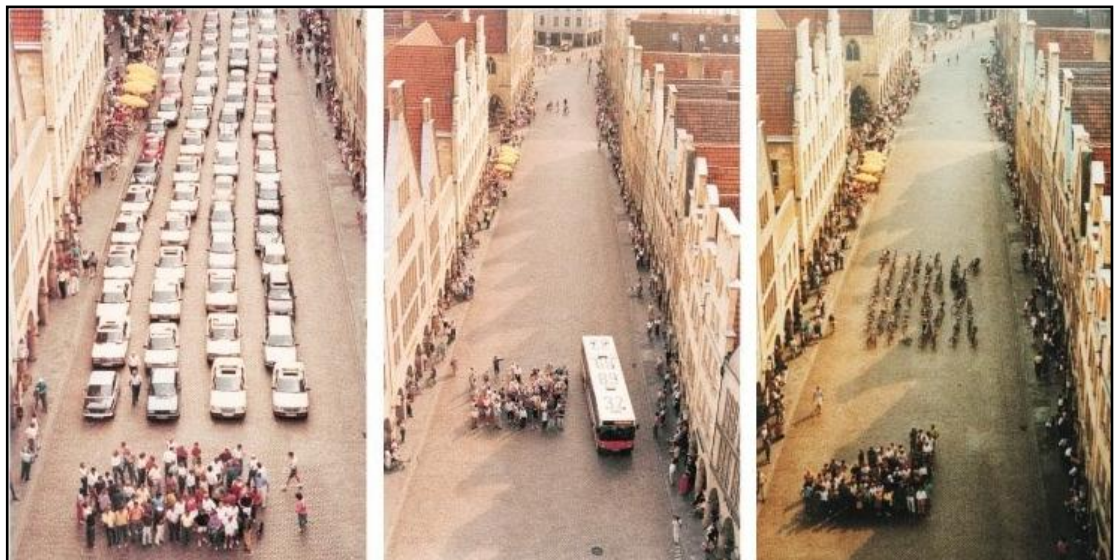
Figura 4.28.- Cantidad de espacio requerido para transportar el mismo número de personas, en automóvil, bus y bicicleta.
