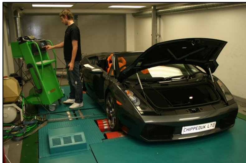
Figura 4.7.- Prueba dinámica de emisiones en estado estable, utilización del banco de potencia.
