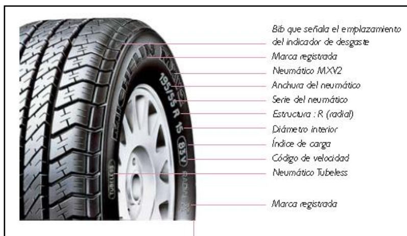
Figura 2.21.- Descripción marcas del neumático.
