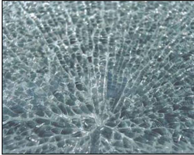
Figura 3.27.- Comportamiento del vidrio templado en caso de rotura.
