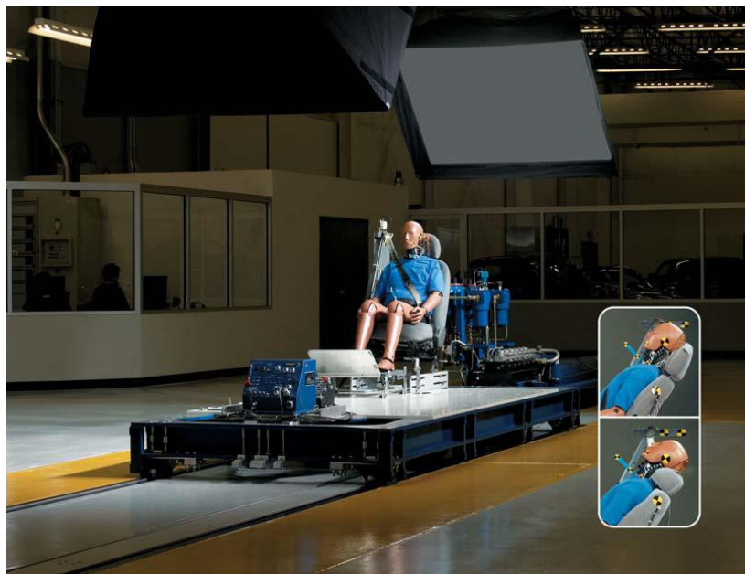
Figura 3.41.- Ensayo dinámico para analizar la efectividad del apoyacabezas en una colisión por alcance.
