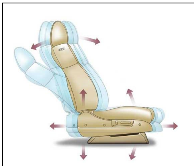
Figura 3.8.- Movimientos de un asiento ajustable.
