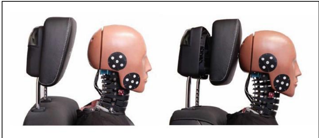
Figura 3.10.- Funcionamiento del apoyacabezas activo.
