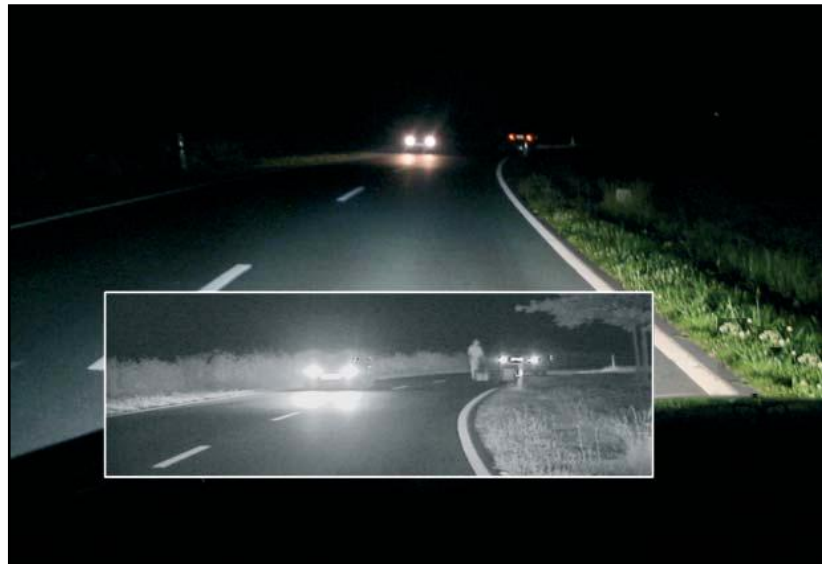
Figura 2.2.- Sistema de visión nocturna de HELLA.
