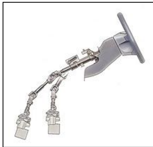
Figura 3.19.- Funcionamiento columna de dirección colapsable.
