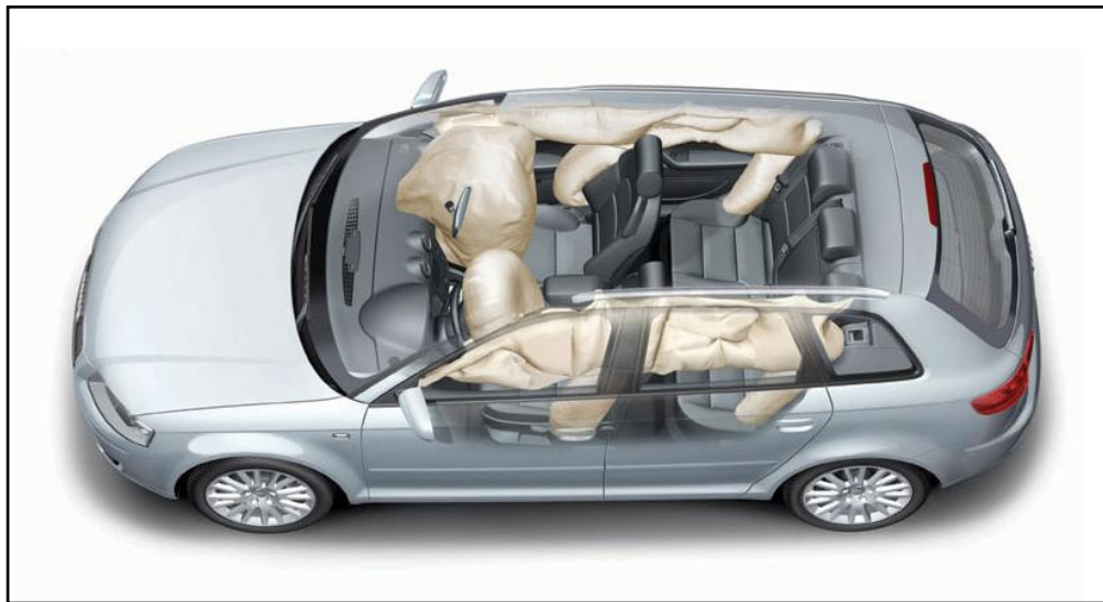
Figura 3.16.- Disposición de los airbags Audi A3.
