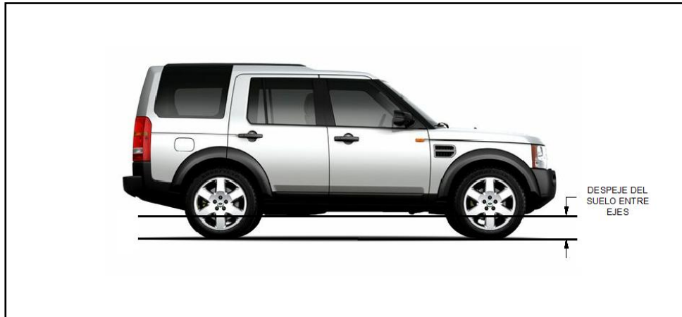
Figura 1.3.- Despeje al suelo entre ejes.
