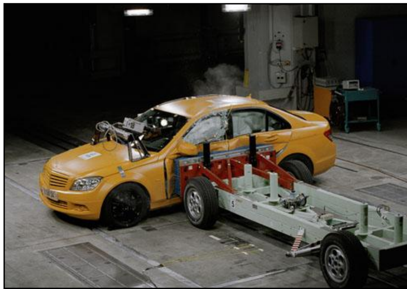
Figura 3.35.- Ensayo de impacto lateral, Mercedes Benz S500.
