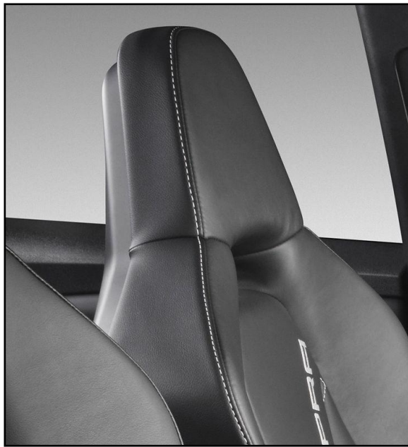
Figura 3.9.- Apoyacabezas fijo o integrado.
