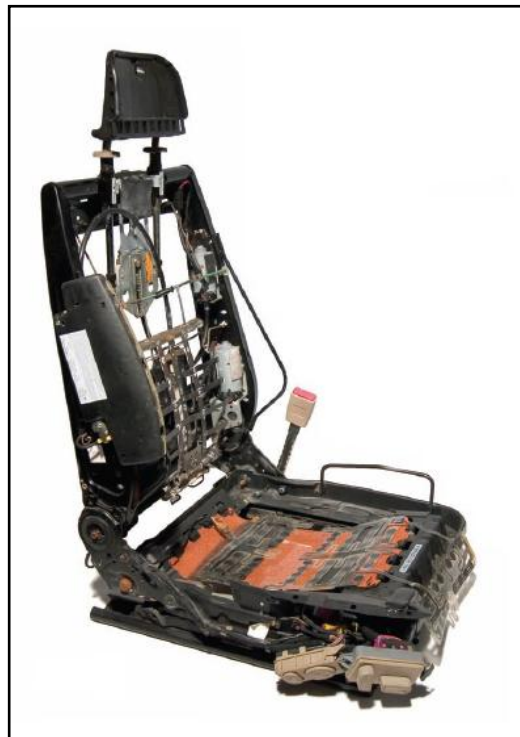
Figura 3.7.- Estructura de un asiento moderno.
