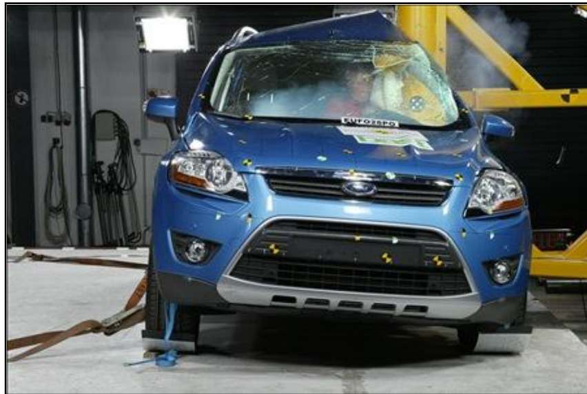
Figura 3.39.- Ensayo de impacto con poste, Ford Kuga.
