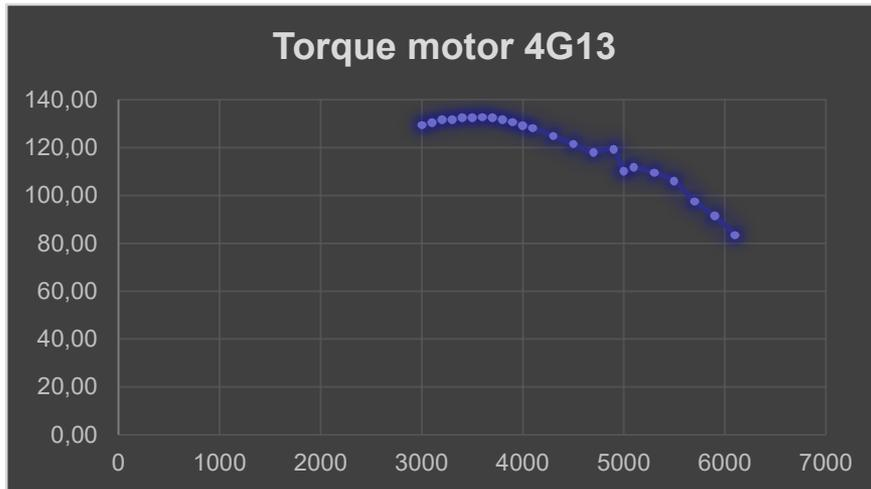
*Nota.* La figura representa el incremento del torque del motor cuando aumenta el rpm y llegue a su máximo y vuelva a descender.
