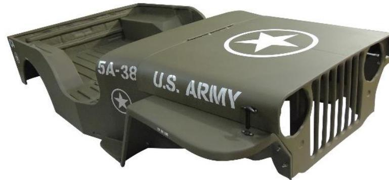
Se encuentra fabricada en su totalidad de chapa de acero, a la cual se le añaden diversas monturas para que pueda fijarse sobre el bastidor
