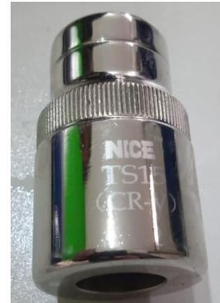
Útil para afloje o ajuste de la tuerca de la tobera del inyector. “TS15(CR-V)”.
