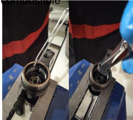
Ajustar la tuerca interna de la válvula de control con el útil respectivo y al torque según especificaciones
