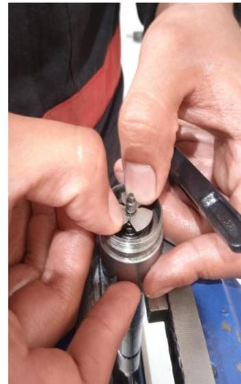
Colocar en el interior de la bobina el resorte y anillo de calibración, con la ayuda de un aceitero lubricar el interior y la circunferencia de la bobina para su montaje
