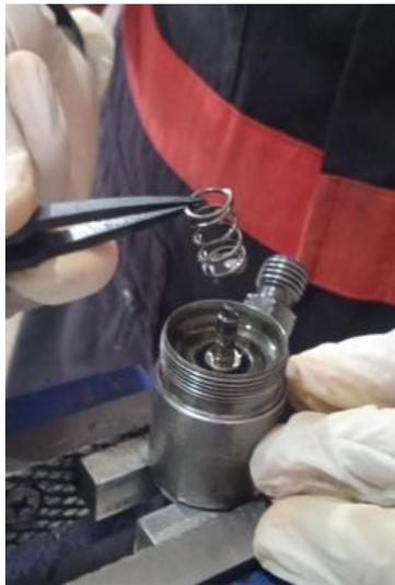
Extraer el anillo de ajuste o arandela de separación de la bobina
