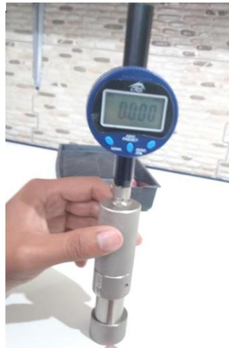
Colocar el reloj palpador en la base del inyector para tomar datos de la altura del DNH.
