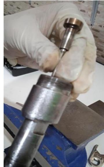
Emplear el útil D17 para extraer el teflón del cuerpo del inyector para verificar las condiciones en las que este se encuentre.
