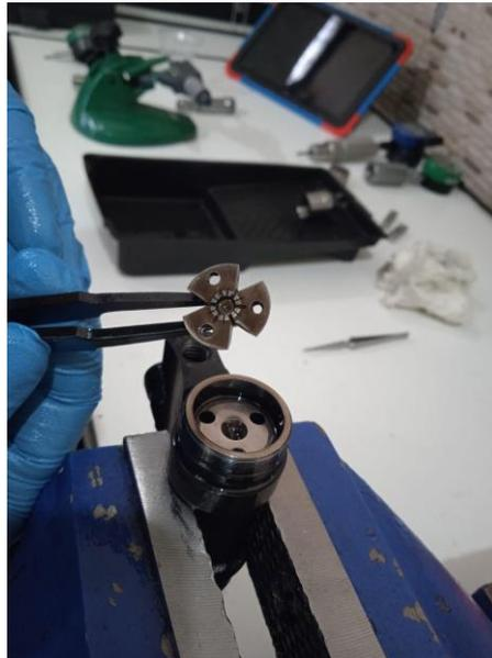
Aflojar la tuerca interna de la válvula de control con el acople D01 – CCR y retirar.
