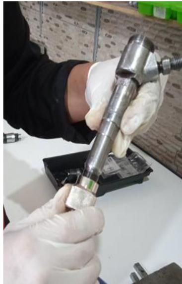
Extraer la válvula y émbolo (plunger) del cuerpo del inyector.
