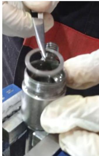
Extraer la tuerca de sujeción de válvula con el útil TS15 (CR-V5) de 10 mm.
