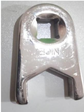
Útil para afloje y ajuste de la tuerca del solenoide del inyector. “XD11-AS29”.
