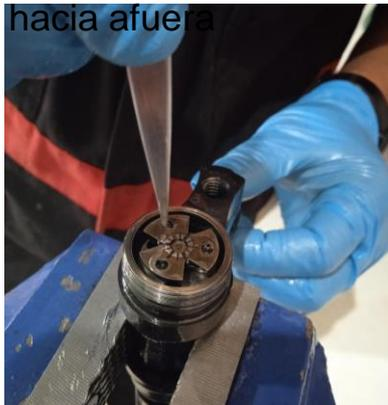
Introducir en la bobina el anillo VFK y el resorte de válvula.
