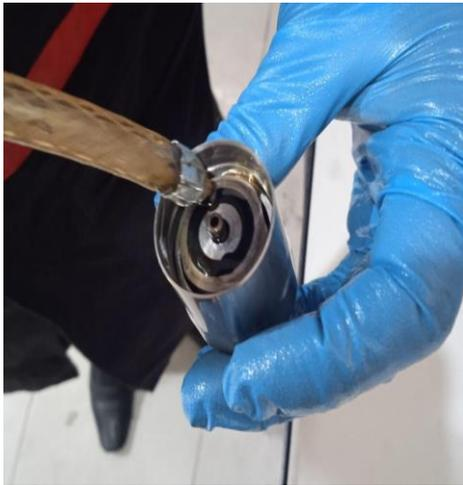
Ajustar la bobina en el cuerpo del inyector con una pequeña presión.
