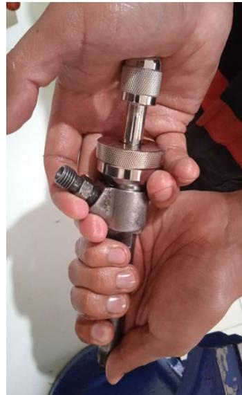
Ubicar la esfera y guía de esfera sobre el conducto de combustible de la válvula
