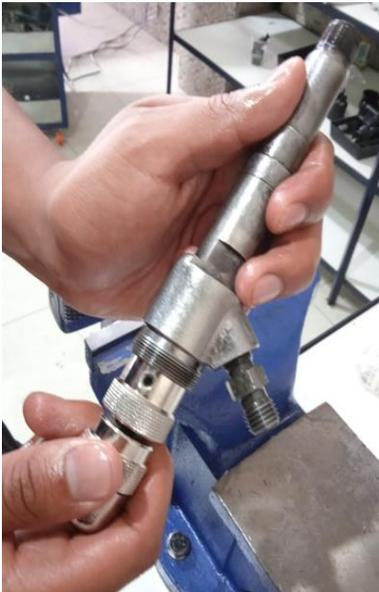
Con la ayuda del útil D13- M27x1 colocar el conjunto de émbolo y válvula en el interior del inyector
