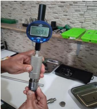
Tomar el rejol palpador y con el útil G09 encerar. Proceder a medir la altura del cuerpo del inyector hacia el inducido
