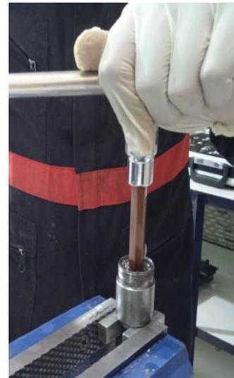
Una vez removida la tuerca de sujeción se retira el control de válvula en conjunto con el anillo de calibración AH.
