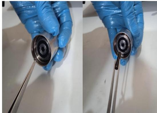
Ingresar el anillo de ajuste o arandela de separación en la bobina
