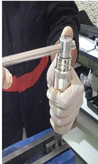
Extraer el conjunto interno de la sección de tobera, correspondiente a la arandela de calibración DNH y su guía.
