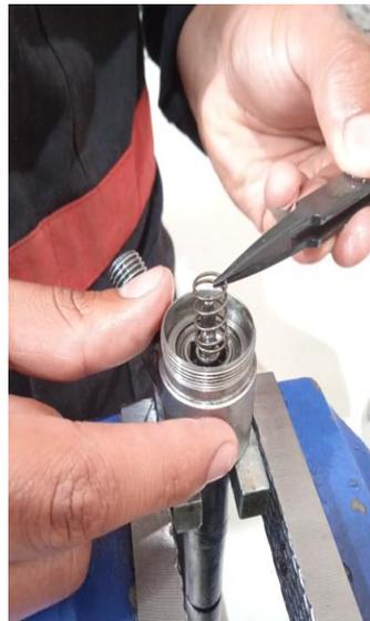
Aplicar leves movimientos verticales sobre el inducido para comprobar que este se encuentre posicionado correctamente
