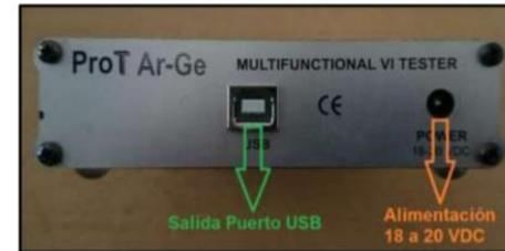
3. Realizar la conexión del cable de alimentación
