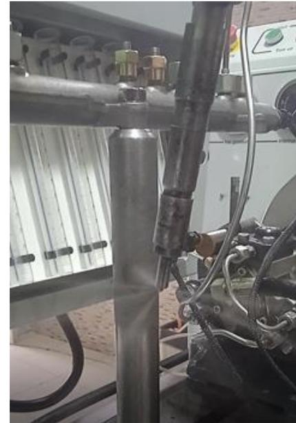
**Control de pulverización del inyector**
