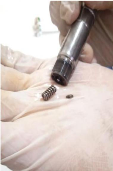
Una vez removida la sección interna, emplear el útil D20-M15X0.5.
