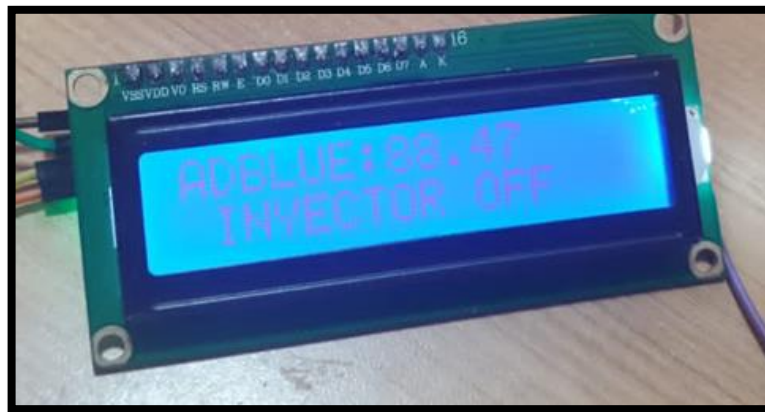
Figura 20 Visualización de datos en el pantalla LCD
