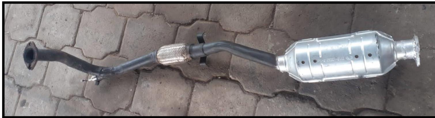
Figura 6 Sistema de Escape con sistema SCR
