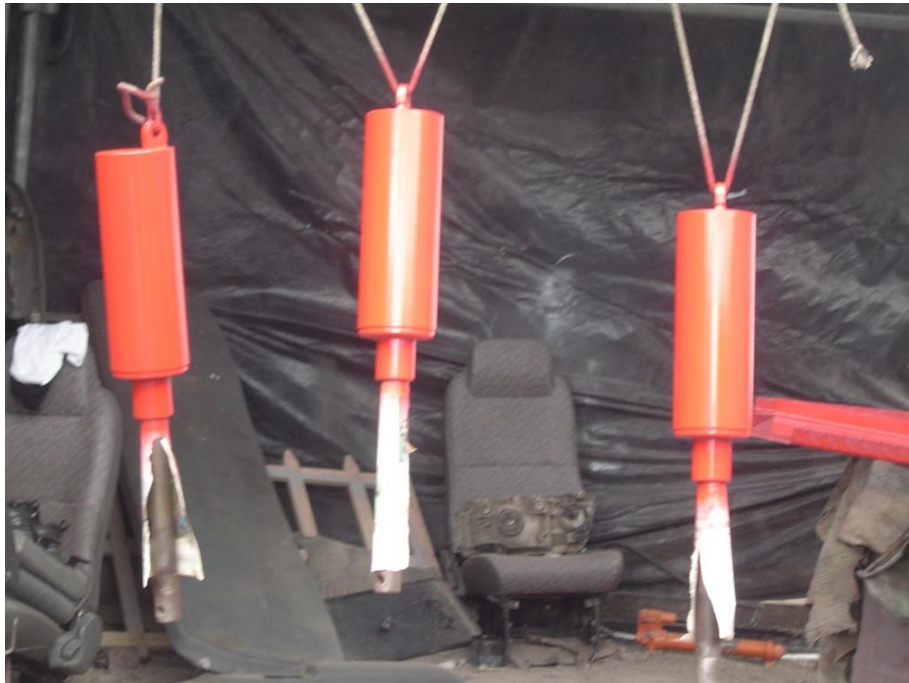
Figura 4-20 Pintura de Cilindros
