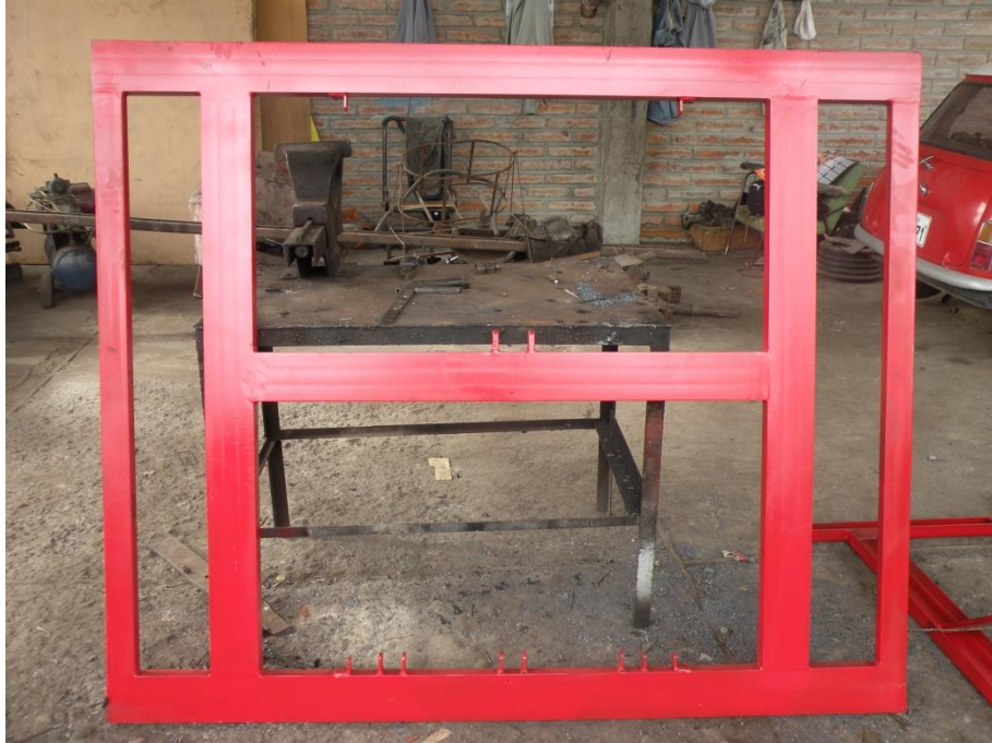
Figura 4-19 Pintura de la estructura
