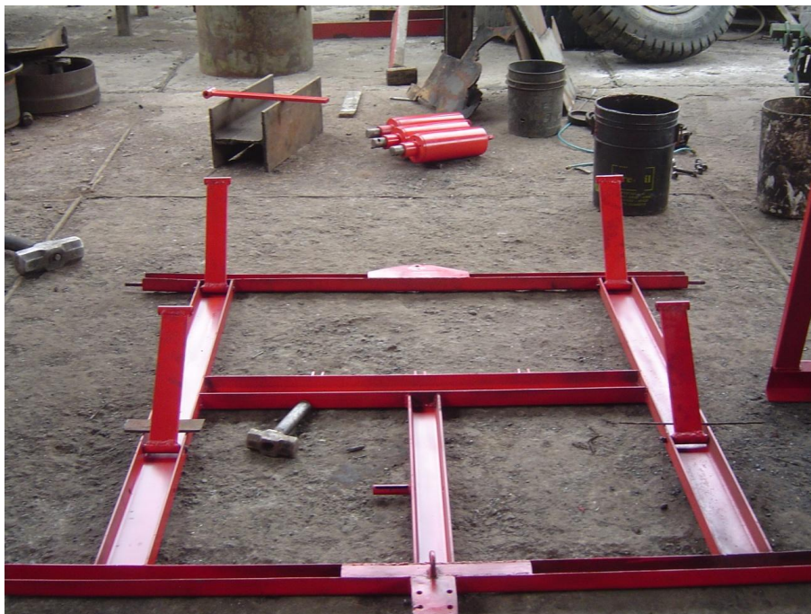
Figura 4-24 Colocación de guías
