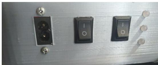
*Nota.* (De izquierda a derecha) Conector para cargar los componentes; Interruptor para carga de dispositivo Android; Interruptor para carga de batería Li-Po; Indicadores de carga de batería Li-Po.
