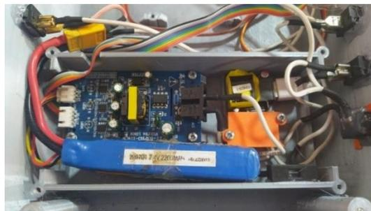
*Nota.* a. Zona de componentes de carga con la tapa protectora. b. Componentes utilizados para recargar la placa principal y el dispositivo Android.
