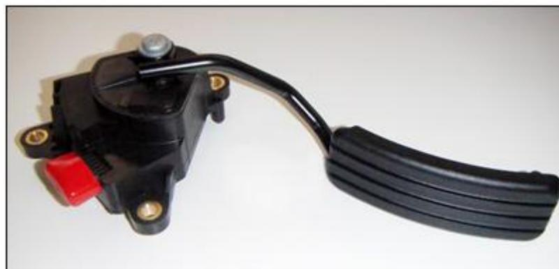
**Figura 2.7. Pedal con potenciómetro integrado**
