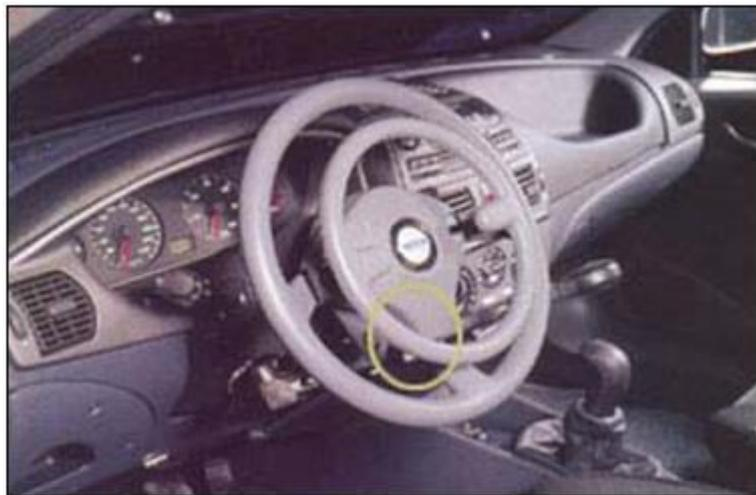
**Figura 2.1. Acelerador en vehículos especiales**
