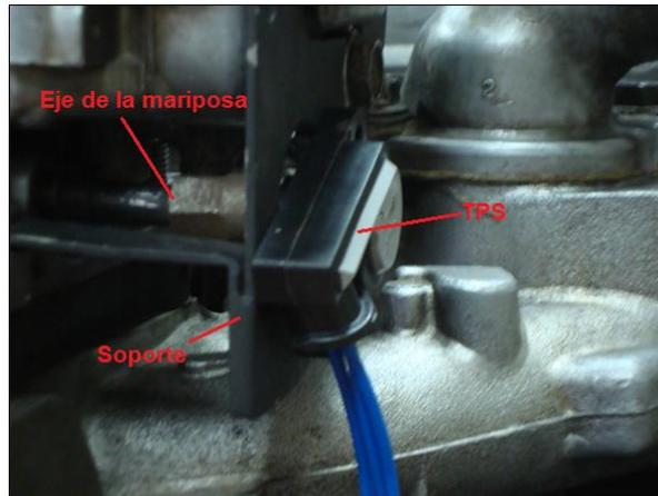
**Figura 4.24. Montaje del soporte del TPS**
