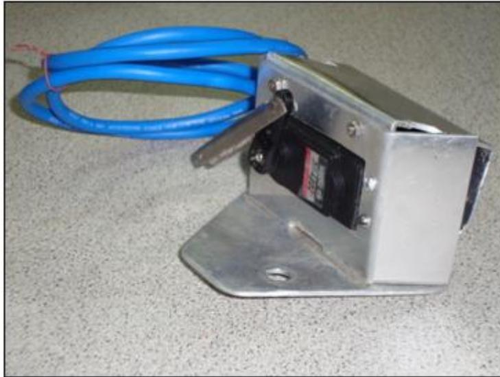
**Figura 3.15. Soporte con el servomotor**
