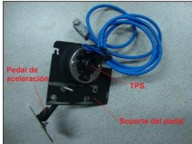
Figura 2.19. Partes del pedal de aceleración
