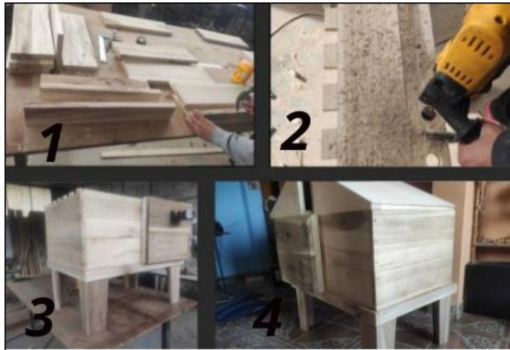
*Nota.* 1. Cortes de madera. 2. Mecanizado de figuras. 3. Armado de caja. 4.
