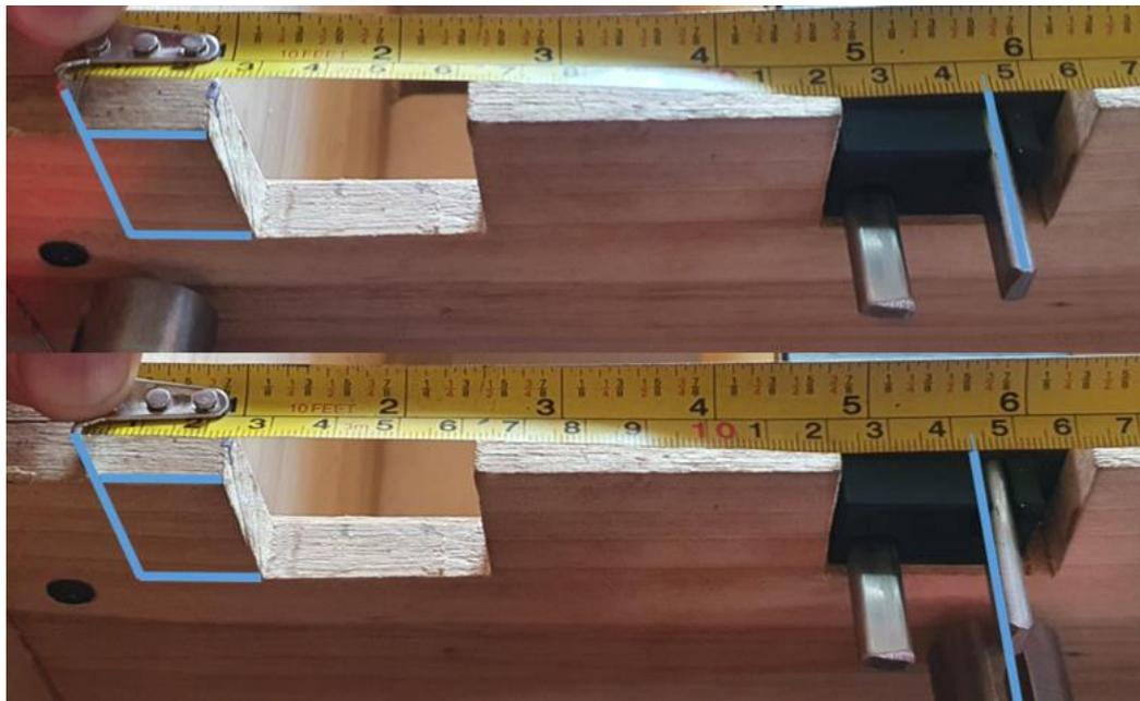
*Nota.* En la parte superior de la imagen se observa la distancia hasta la palanca más alejada, la parte inferior muestra la distancia que recorrió el actuador.
