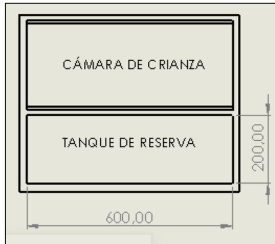
Para calcular las medidas restantes que permitan completar el volumen máximo de  $13800 \text{ cm}^3$ . A partir de medidas preestablecidas como se muestran en la figura 30 y teniendo en cuenta una forma de tanque en la cual la miel pueda fluir por medio de gravedad en una superficie inclinada.
