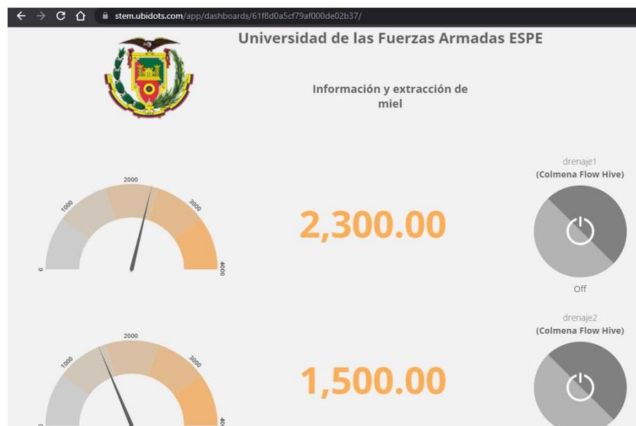
El botón creado para la extracción de miel es colocado en caso de que el apicultor requiera de miel en cualquier instante de producción, pero además de ello hay que recordar que el sistema es automático, de tal manera que los panales en base a la programación de Raspberry Pi se cosechan automáticamente cuando se encuentran llenos o cuando el apicultor presione el botón.
