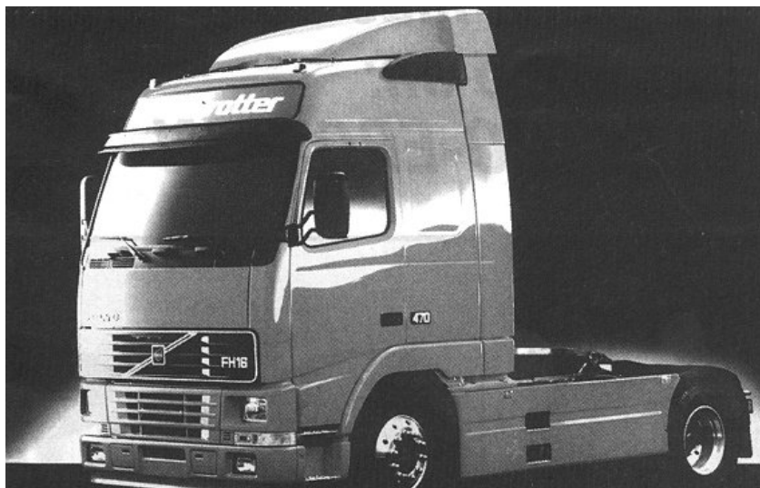
GRÁFICO II.8: CARROCERÍA DE CAMIÓN CON ELEMENTOS DE PLÁSTICO Y COMPOSITE EN TODO EL EXTERIOR
