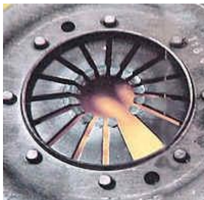
Fig. 1.60 Rotura de lengüeta del diafragma
