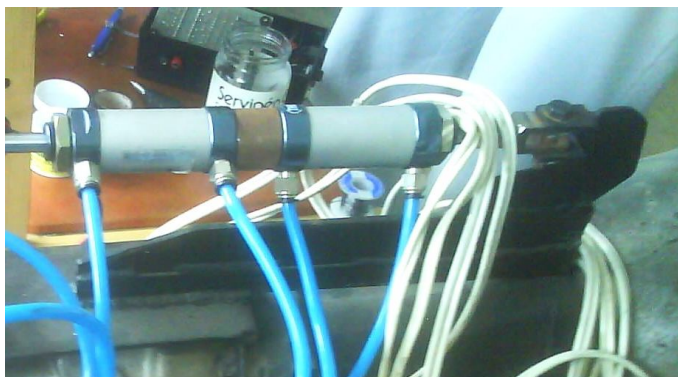
Fig. 3.24 Soporte para los cilindros de movimiento vertical de la palanca de cambios
