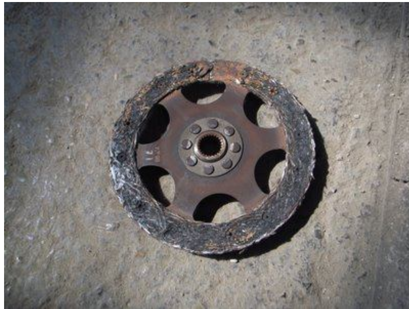
Fig. 1.59 Disco de Embrague Quemado
