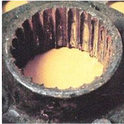
Fig. 1.58 Estriado de la Maza Destruido
