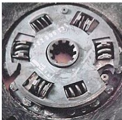
Fig. 1.61 Grieta en el disco de embrague.
