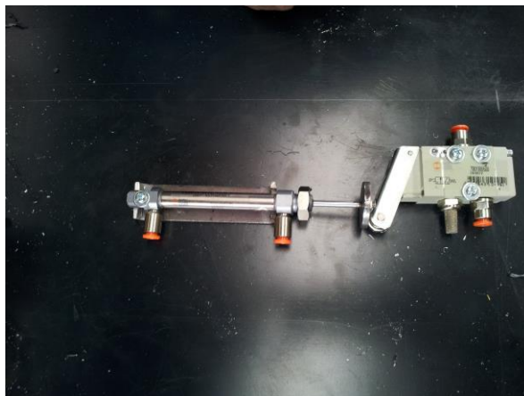
Figura 3.10 Procedimiento de medida del vástago a la válvula Fuente: Investigación de Campo
