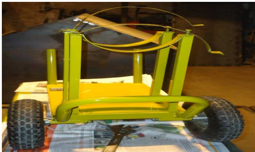
Fig: 3.3. Estructura de soporte de la hidrolavadora.
