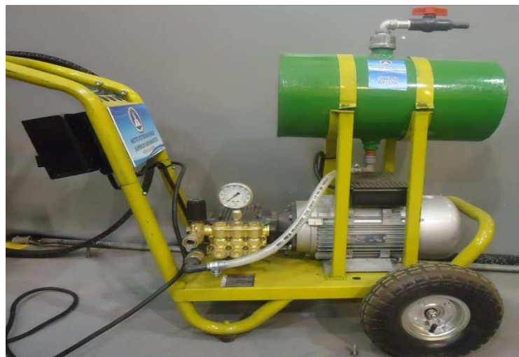
Fig: 3.17. Pintado y ensamblado de la hidrolavadora completo.
