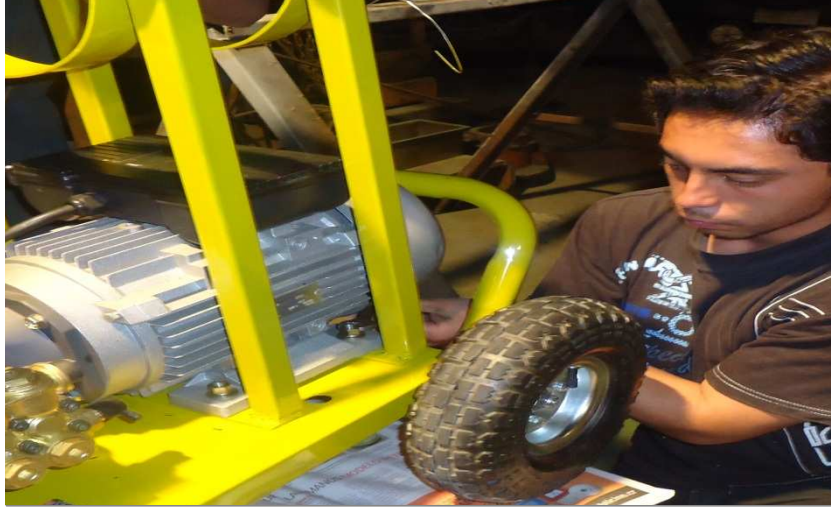
Fig: 3.15. Colocación de llantas.
