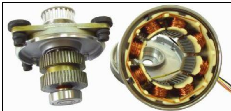
Figura 2.2. Rotor y estator de 8 polos.
