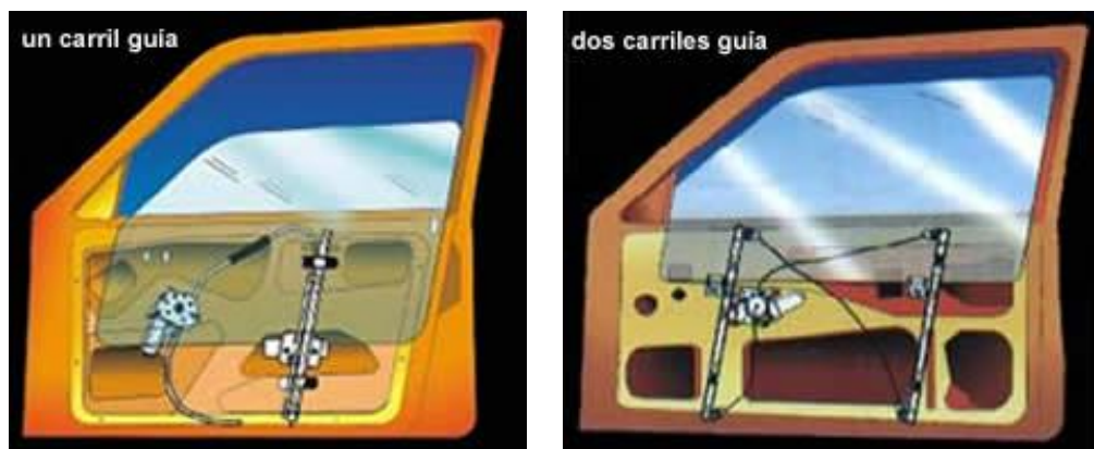
Figura 1.12. Mecanismo de elevalunas por cable de tracción.
