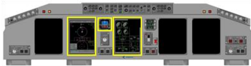
Figura 2.14. Pantallas 2 MFD (Del Lado del Piloto) y 3 EICAS estén prendidas Fuente: Manual Embraer 170/190 Power Up and Power Down Procedures
