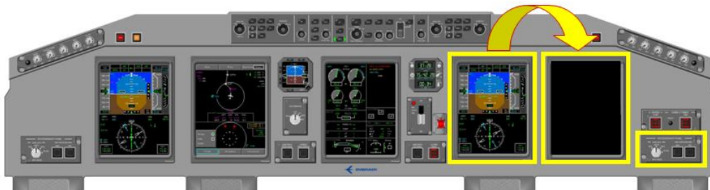
Figura 2.25. Ubicación de las Pantallas 4 y 5 por medio del Reversionary Panel
