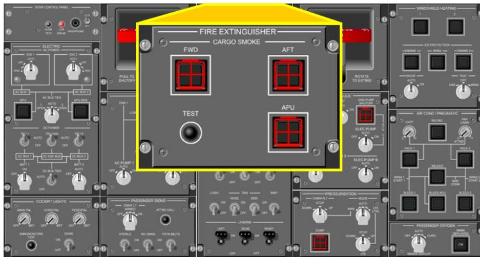
Figura 2.26. Panel de Extinción de Fuego
