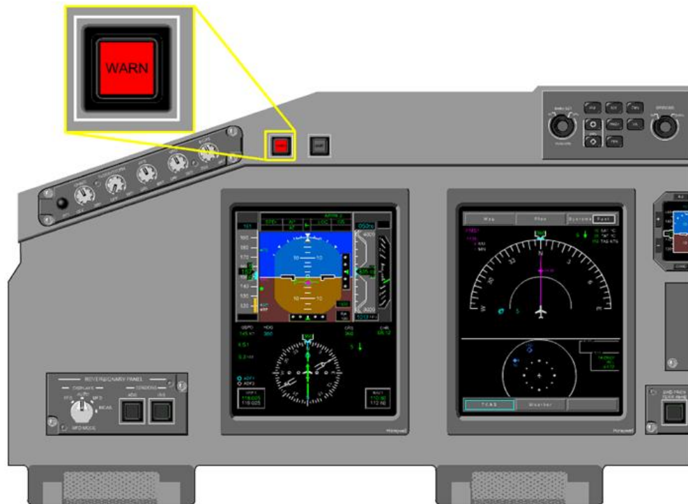
Figura 2.29. Iluminación del Test de Fuego Fuente: Manual Embraer 170/190 Power Up and Power Down Procedures
