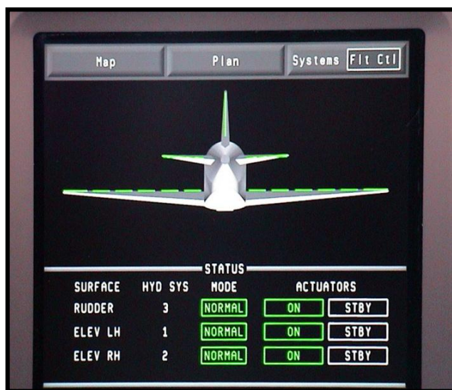
Figura 2.23. Disponible Energía Hidráulica Fuente: Manual Embraer 170/190 Power Up and Power Down Procedures
