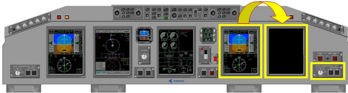
Figura 2.40. Ubicación de las Pantallas 4 y 5 por medio del Reversionary Panel Fuente: Manual Embraer 170/190 Power Up and Power Down Procedures
