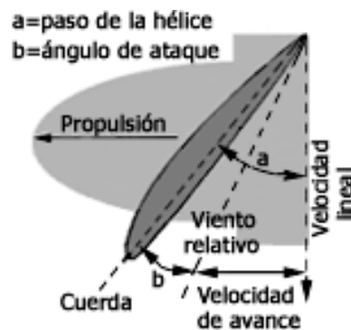
Figura 2. 3 Funcionamiento de la Hélice
