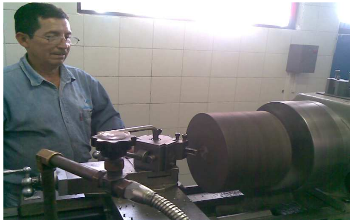
Figura 3. 20 Construcción del Acople
