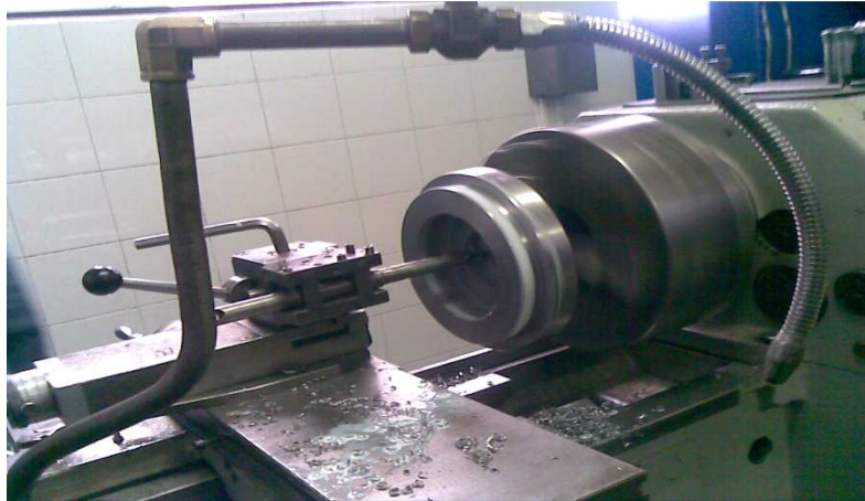
Figura 3. 21 Construcción de Agujeros del Soporte
