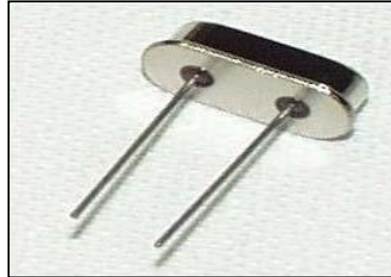
Figura 3.19.- Oscilador de cristal
