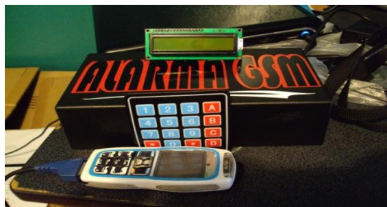
Figura 4.15.- Módulo del sistema de bloqueo GSM
