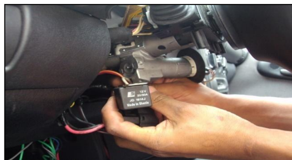
Figura 4.12.- Conexión del relé del sistema de ignición
