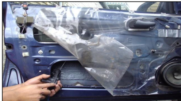
Figura 4.11.- Conexiones de los motores de las puertas
