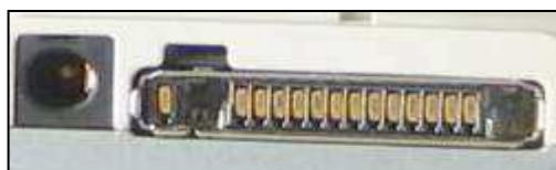
Figura 2.14.- Conector del teléfono Nokia 3220
