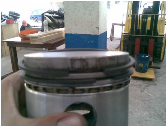
Figura 25. Instalación de anillos
