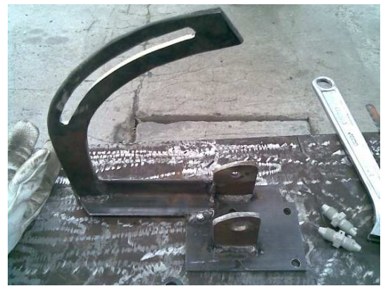
Figura 38. Inspección suelda soporte Alternador
