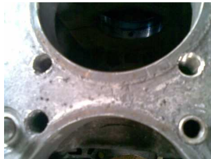
Figura 3. 50. Aclaración de rosca en el cárter Fuente: Investigación de campo. Editado por: Omar Flores
