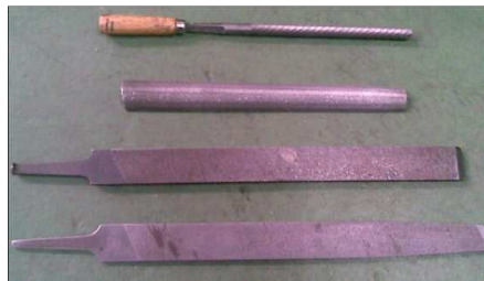
Figura 3.33. Tipos de limas según su forma transversal Fuente: Investigación de campo. Editado por: Omar Flores
