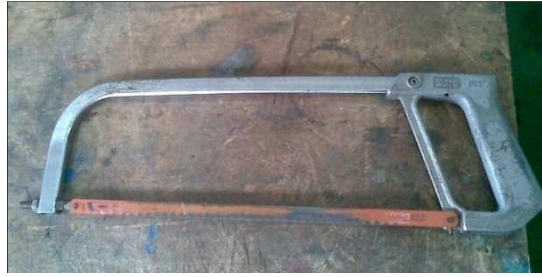
Figura 3.18. Arco de sierra y sus partes Fuente: Investigación de campo. Editado por: Omar Flores
