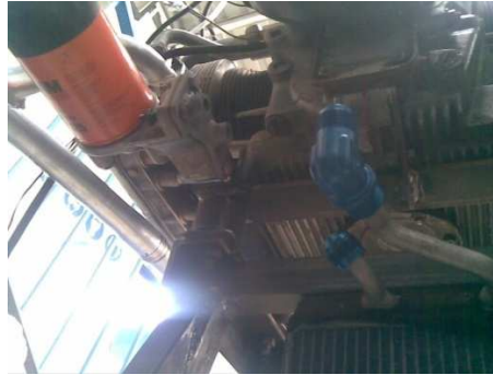
Figura 3. 88. Soporte filtro de aceite pintado. Fuente: Investigación de campo. Editado por: Omar Flores
