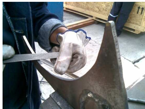
Figura 34. Limado del soporte
