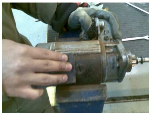
Figura 3. 74. Limpieza del motor de arranque. Fuente: Investigación de campo. Editado por: Omar Flores
