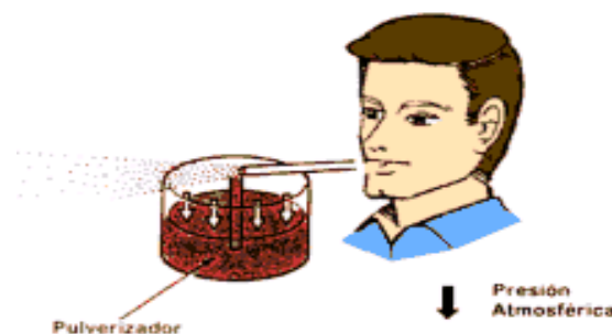
Figura 2.40. Principio de operación del carburador Fuente: Investigación documental Tomado de: Automecánico, “carburador”
