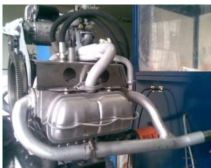
Figura 3. 93. Sistema de Admisión y Escape. Fuente: Investigación de campo. Editado por: Omar Flores
