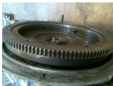
33 Figura 3. 56. Desmontaje del volante. Fuente: Investigación de campo. Editado por: Omar Flores
