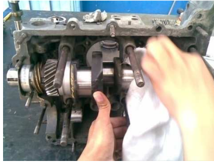
Figura 3.63. Instalación del cigüeñal. Fuente: Investigación de campo. Editado por: Omar Flores
