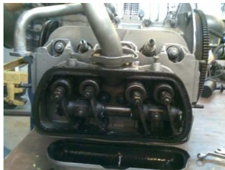
Figura 3.47. Retiro cubiertas de válvulas Fuente: Investigación de campo. Editado por: Omar Flores
