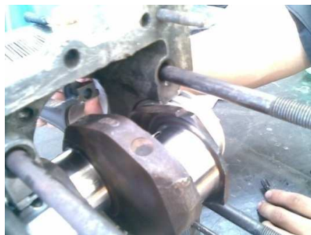
Figura 3. 65. Instalación de bielas. Fuente: Investigación de campo. Editado por: Omar Flores
