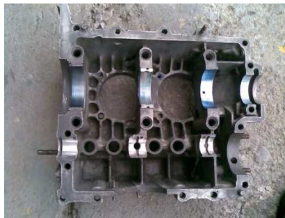
Figura 3. 49. Inspección del cárter Fuente: Investigación de campo. Editado por: Omar Flores
