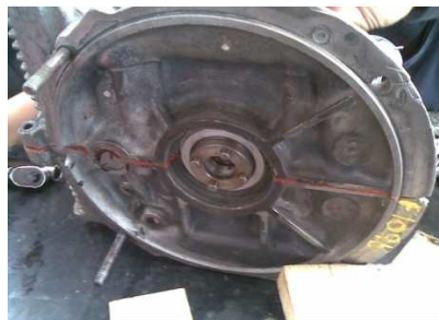
Figura 3. 48. Retiro de la mitad derecha del cárter Fuente: Investigación de campo. Editado por: Omar Flores
