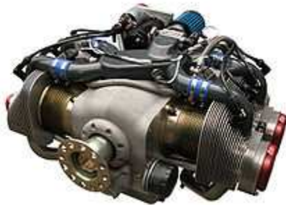
Figura 2.5. Motor Bóxer Aeronáutico Fuente: Investigación documental Tomado de: ACADEMIC. "Disposición del motor"
