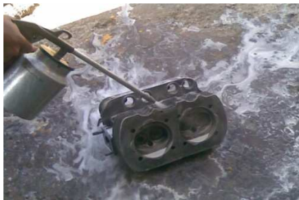
Figura 3. 59. Limpieza cabeza de cilindros. Fuente: Investigación de campo. Editado por: Omar Flores
