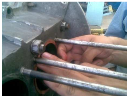
Figura 3. 51. Inspección de espárragos y bielas. Fuente: Investigación de campo. Editado por: Omar Flores
