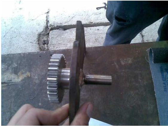
Figura 35. Instalación piñón placa base
