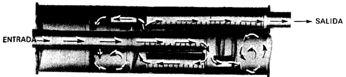
Figura 2.46. Cámara del silenciador Fuente: Investigación documental Tomado de: Billiet, Walter. Entrenamiento y reparación de motores
