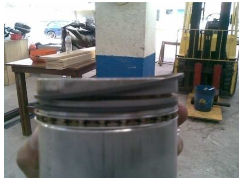
Figura 3. 62. Cambio de anillos de los pistones. Fuente: Investigación de campo. Editado por: Omar Flores
