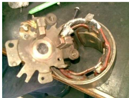
Figura 3. 80. Desarmado y limpieza del alternador. Fuente: Investigación de campo. Editado por: Omar Flores
