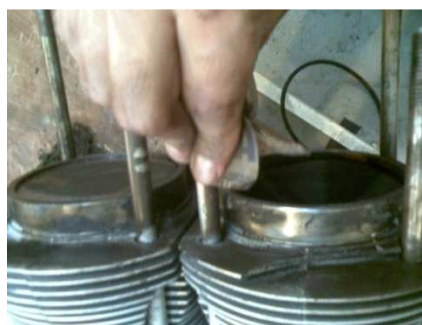
Figura 3. 60. Limpieza de cilindros y espárragos Fuente: Investigación de campo. Editado por: Omar Flores
