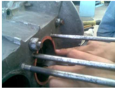
Figura 3. 52. Inspección de bielas. Fuente: Investigación de campo. Editado por: Omar Flores
