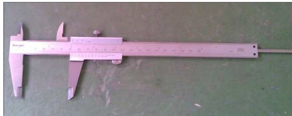
Figura 3.20. Calibrador pie de rey Fuente: Investigación de campo. Editado por: Omar Flores
