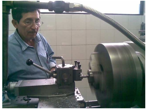
Figura 18. Trabajo en varilla de acero de transmisión
