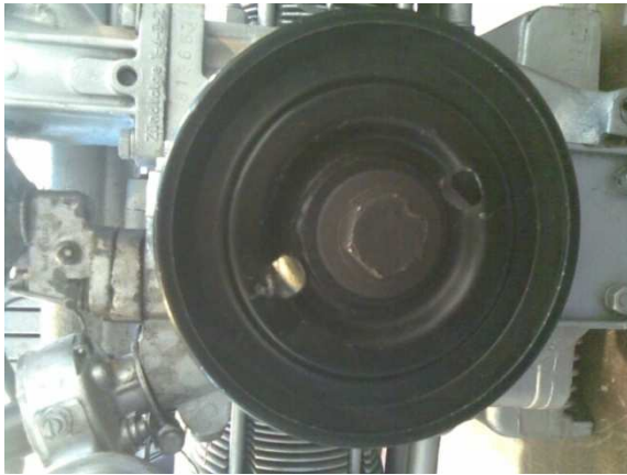
Figura 17. Retiro base guía de la polea
