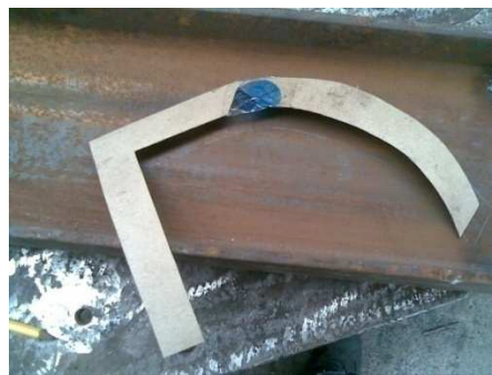
Figura 3. 81. Plantilla para soporte del alternador.
