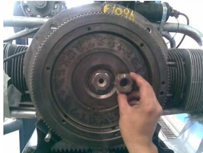
Figura 3. 66. Instalación del volante. Fuente: Investigación de campo. Editado por: Omar Flores
