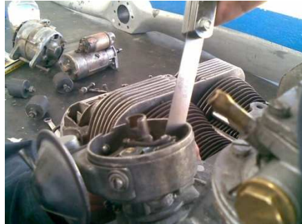
Figura 3. 71. Calibrado de platinos. Fuente: Investigación de campo. Editado por: Omar Flores
