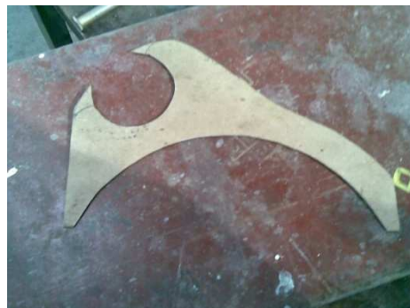
Figura 3. 76. Construcción soporte motor arranque. Fuente: Investigación de campo. Editado por: Omar Flores
