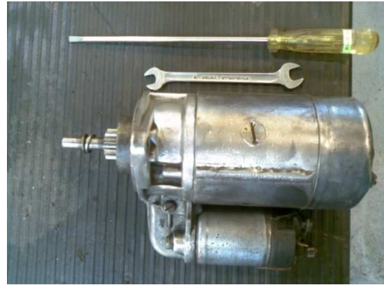
Figura 30. Inspección del motor de arranque
