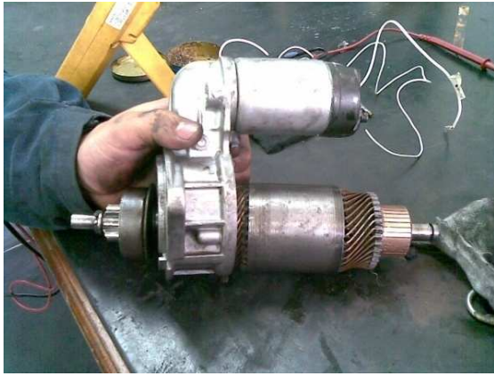
Figura 29. Desarmado y mantenimiento del arranque
