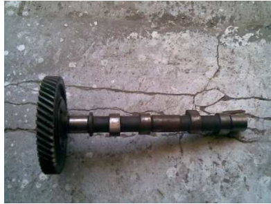
Figura 3. 55. Inspección del árbol de levas. Fuente: Investigación de campo. Editado por: Omar Flores
