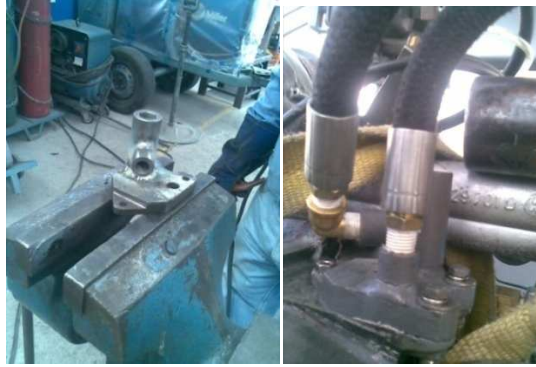
Figura 3. 85. Base que reemplaza el antiguo radiador. Fuente: Investigación de campo. Editado por: Omar Flores
