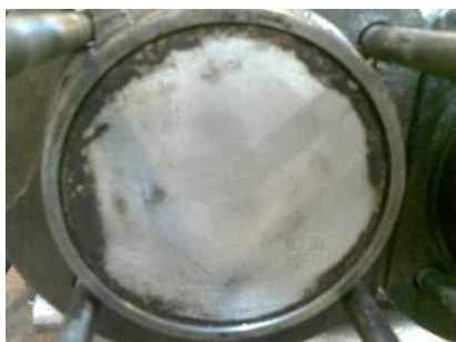
Figura 3. 61. Limpieza e inspección de pistones. Fuente: Investigación de campo. Editado por: Omar Flores
