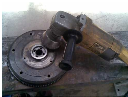
Figura 3. 57. Limpieza del volante. Fuente: Investigación de campo. Editado por: Omar Flores
