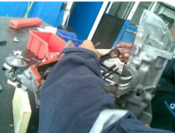
Figura 27. Montaje de bielas al cigüeñal
