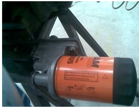
Figura 3. 87. Unión del filtro al motor. Fuente: Investigación de campo. Editado por: Omar Flores
