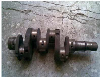
Figura 3. 54. Cambio del cigüeñal. Fuente: Investigación de campo. Editado por: Omar Flores
