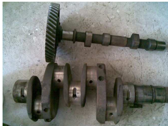
Figura 22. Cambio de cigüeñal y árbol de levas
