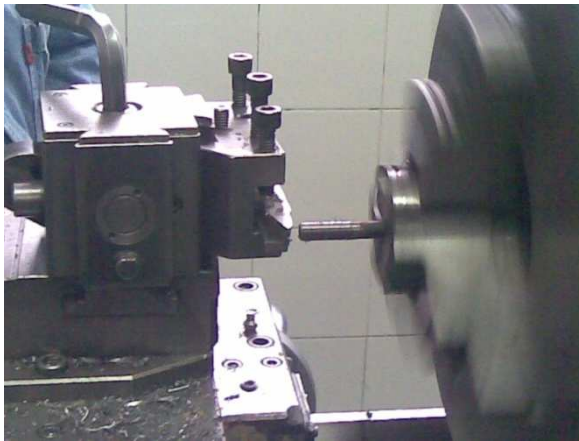
Figura 19. Proceso de roscado de varilla
