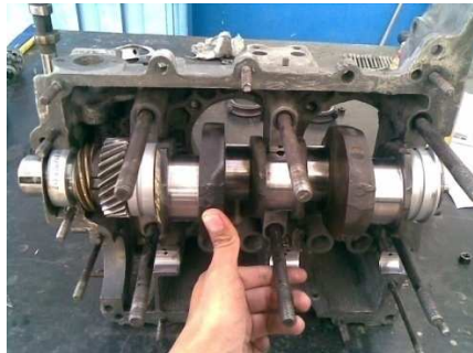
Figura 3. 53. Inspección del cigüeñal Fuente: Investigación de campo. Editado por: Omar Flores
