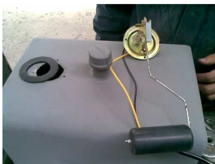
Figura 3. 89. Sistema de medición y tanque de combustible. Fuente: Investigación de campo. Editado por: Omar Flores
