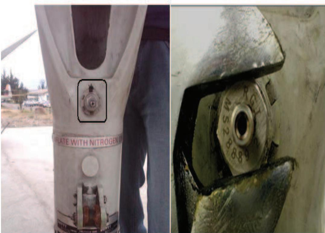
**Figura 3.6:** Descarga de la presión del nitrógeno del soporte de impacto del tren de aterrizaje
