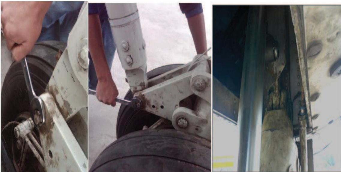
**Figura 3.16:** Desconexión del soporte de arrastre
