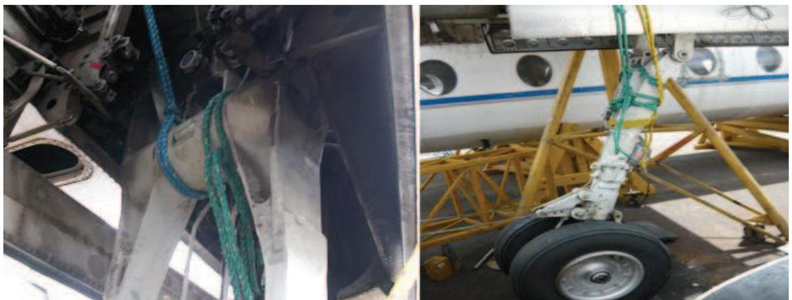
**Figura 3.20:** Desmontaje del soporte de impacto y miembro superior
