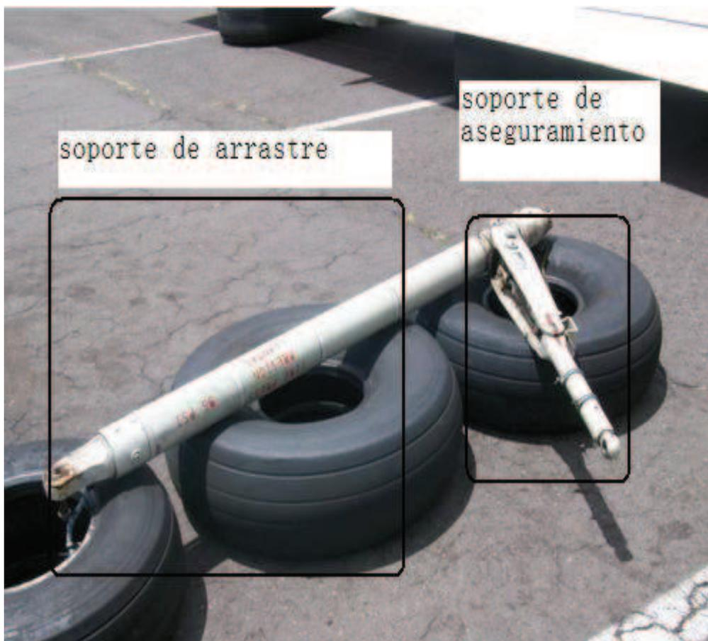
**Figura 3.14:** Soporte de aseguramiento y soporte de arrastre
