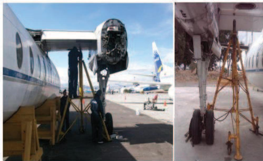
**Figura 3.5:** Ubicación y levantamiento de la aeronave en gatas
