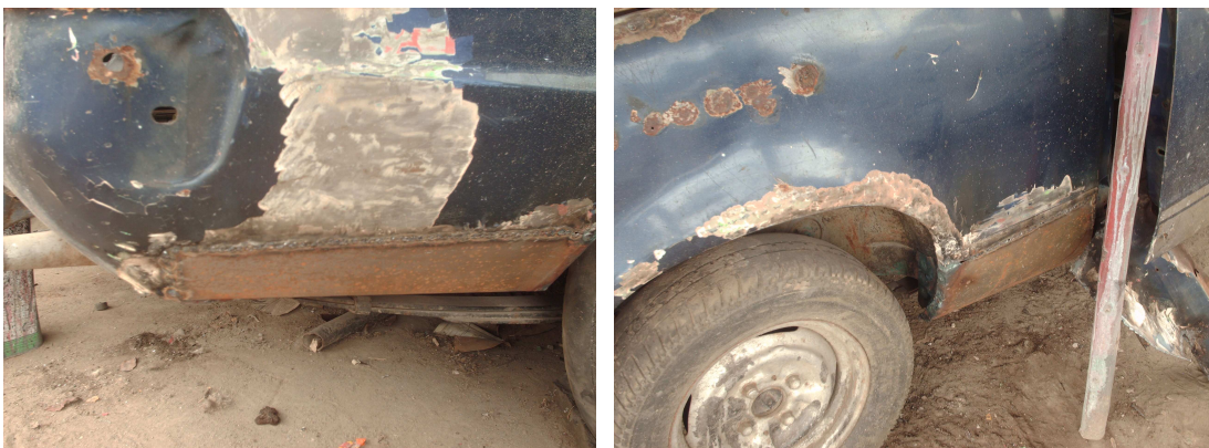
Figura 4.27. Reparaciones exteriores en la carrocería.
