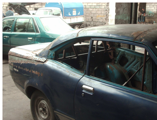
Figura 4.13. Corte de parantes de las puertas, y pieza superior libre.
