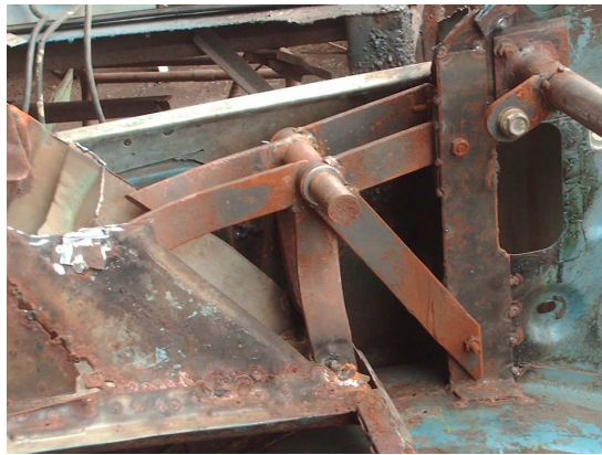
Figura 4.7. Base giratoria con refuerzo.
