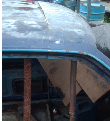
Figura 4.11. Parantes temporales de sujeción de pieza superior.
