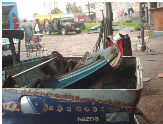
Figura 4.9. Barra que cruza entre refuerzos, para suplir rigidez.
