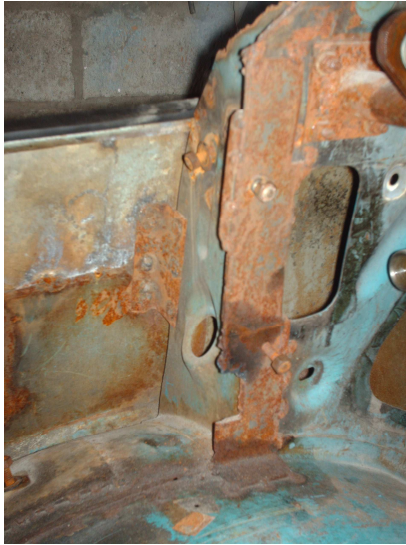
Figura 4.5. Refuerzos en la carrocería para colocar bases.
