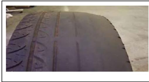
**Fig. 1.2** Desgaste del neumático por variaciones del camber
