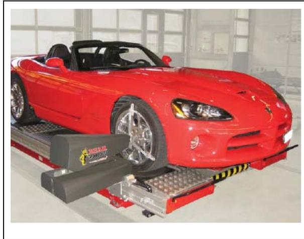
**Fig. 1.54** Plataforma robótica de alineación Bear
