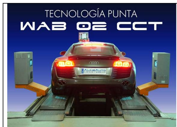
**Fig. 1.51** Vista panorámica de un auto en el robot de alineación WAB 02 CCT
