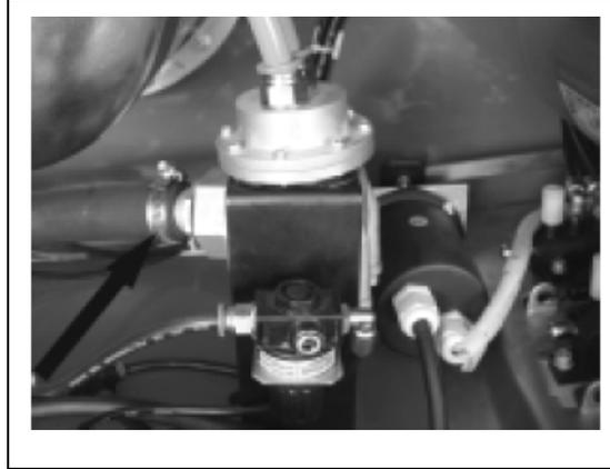
**Fig. 4.8 Válvula de desinflado**
