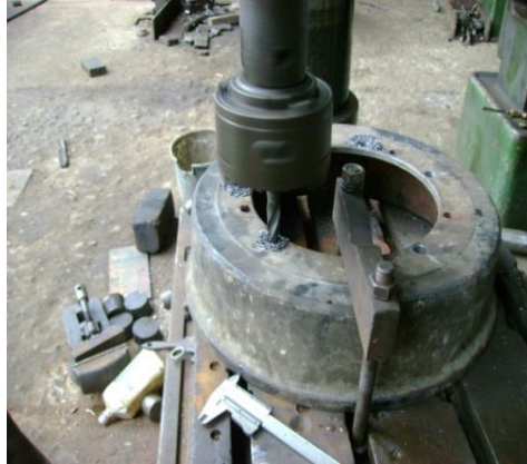
Figura 4.20 Perforaciones en el tambor delantero
