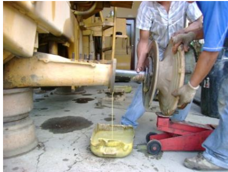
Figura 4.3 Desmontaje de los ejes
