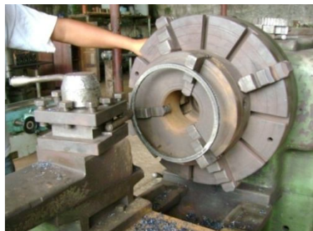
Figura 4.10 Construcción del anillo guía en el torno
