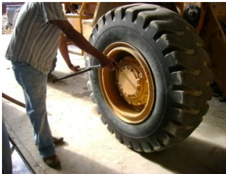
Figura 4.1 Desmontaje de neumáticos
