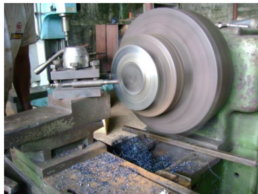
Figura 4.12 Construcción del plato guía en el torno
