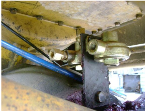
Figura 4.31 Colocación de la válvula 800 posterior
