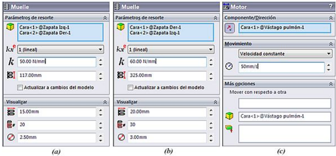
Figura 2.15 Configuración: a) Resorte inferior, b) Resorte superior y c) Velocidad de activación de los frenos
