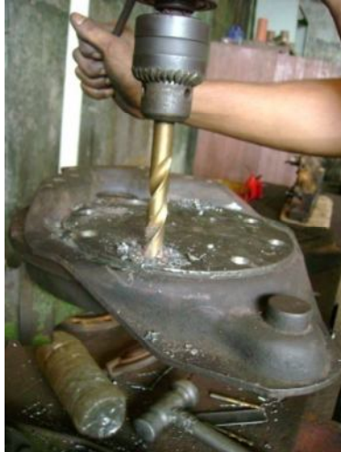
Figura 4.22 Perforaciones en el collarín
