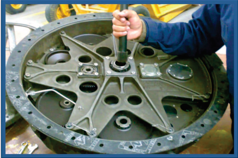
Figura: 3.39Caja de engranajes del motor J-33 y la tapa de la sección de compresión del motor J-65 en el lugar requerido para el mantenimiento
