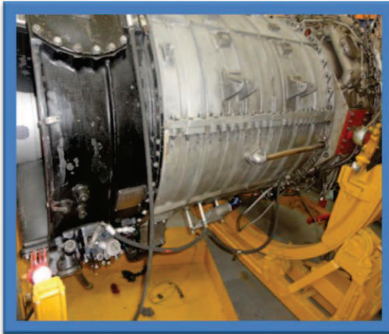
Figura 3.45: Motor J-65 colgado con la eslinga.
