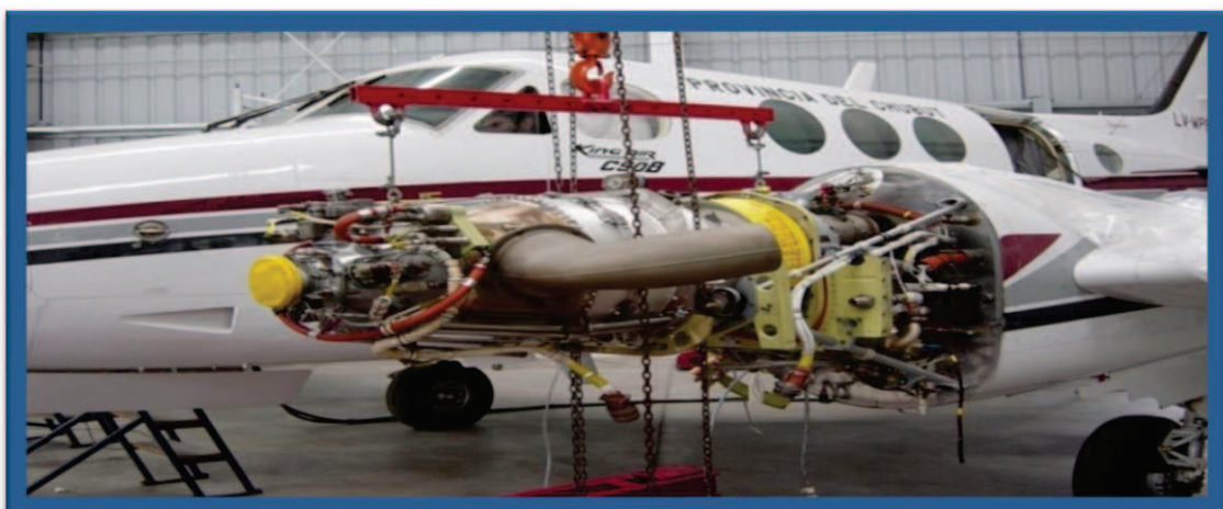
Figura D: Montaje de un motor utilizando la eslinga.
