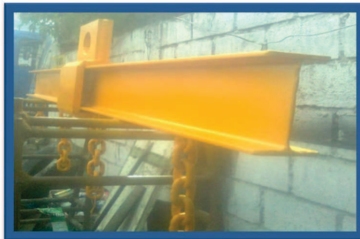
Figuras: 3.38 Cuatro puntos para conectar la eslinga al motor J-65
