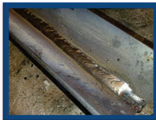
Figura 2.18 Cordón de la suelda MIG
