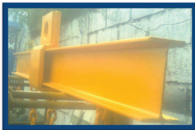
Figura: 2.9 Eslinga para los motores J-65
