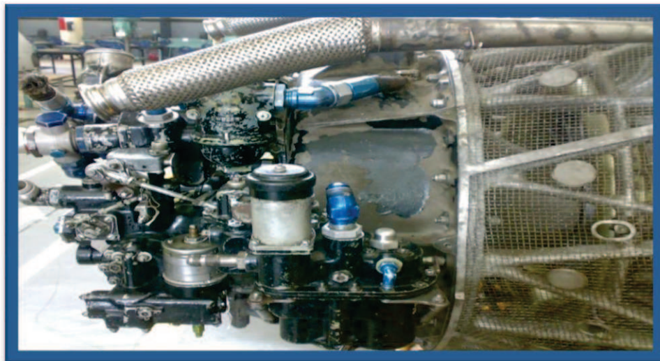
Figura: 3.41 Accesorios ubicados en el lugar de origen en el motor J-33 Fuente: Investigador
