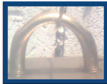
Figura 2.19 Gancho de la eslinga para la caja de engranajes del motor J-33
