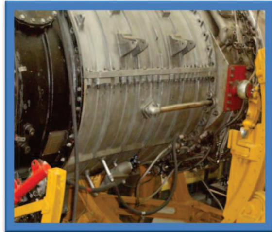
Figura 3.46: Puntos de anclaje desconectados del motor J-65
