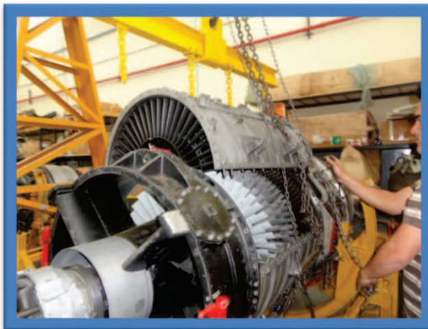
Figura 3.47: Motor J-65 colgado con la eslinga
