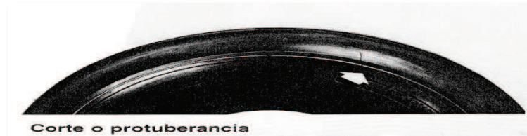
Figura 28. Corte o protuberancia en el neumático
