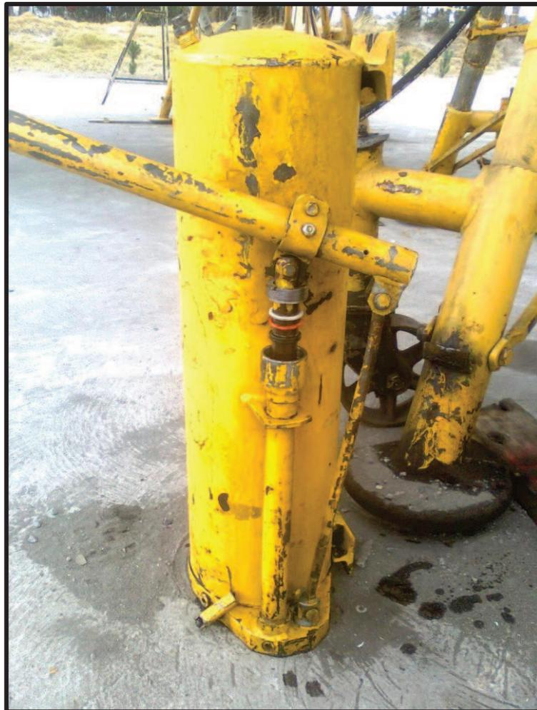
**Figura 3.12:** O ring en mal estado
