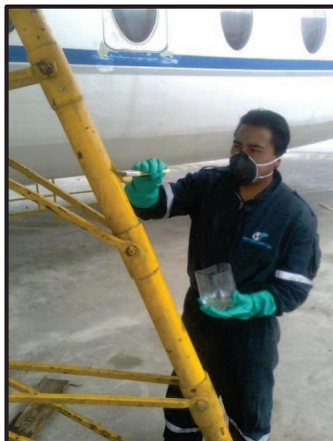
**Figura 3.14:** Aplicación del removedor de pintura
