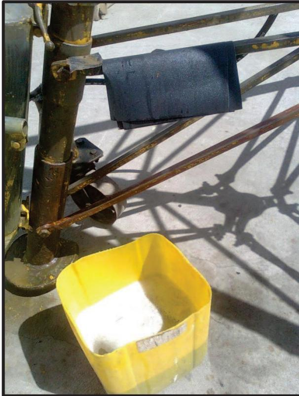
**Figura 3.15:** Utilización de la lija de agua
