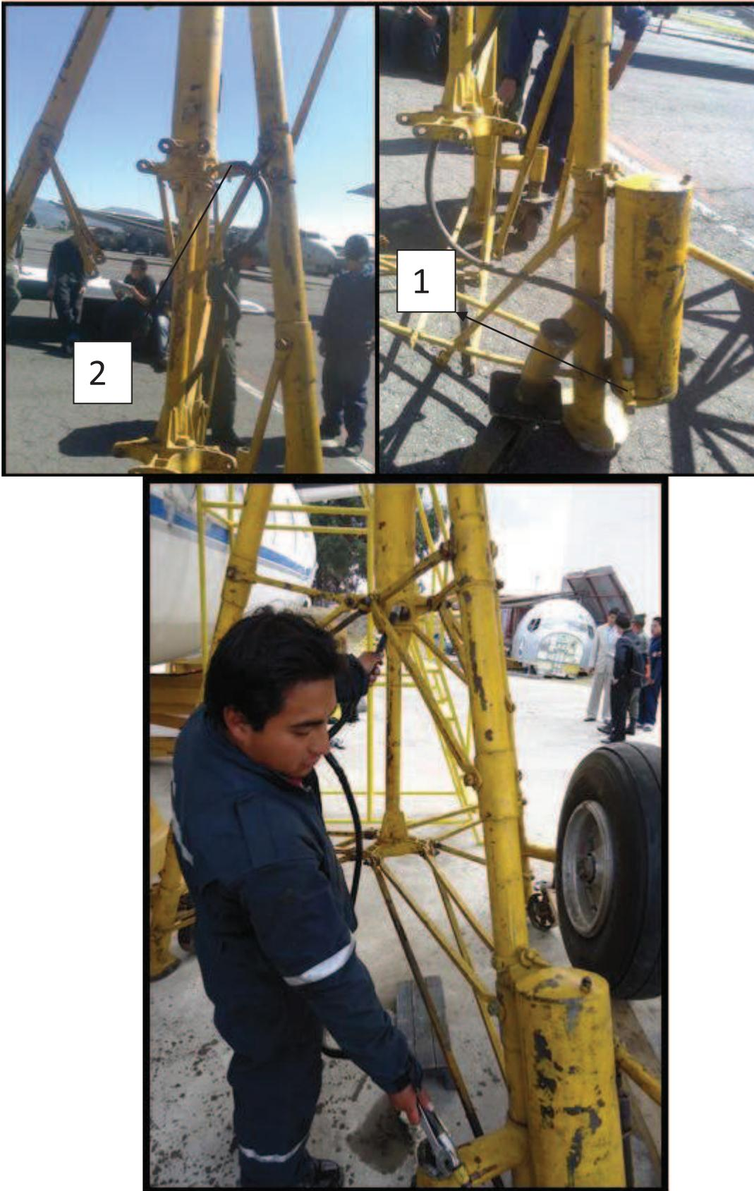
**Figura 3.11:** puntos de desconexión de la manguera
