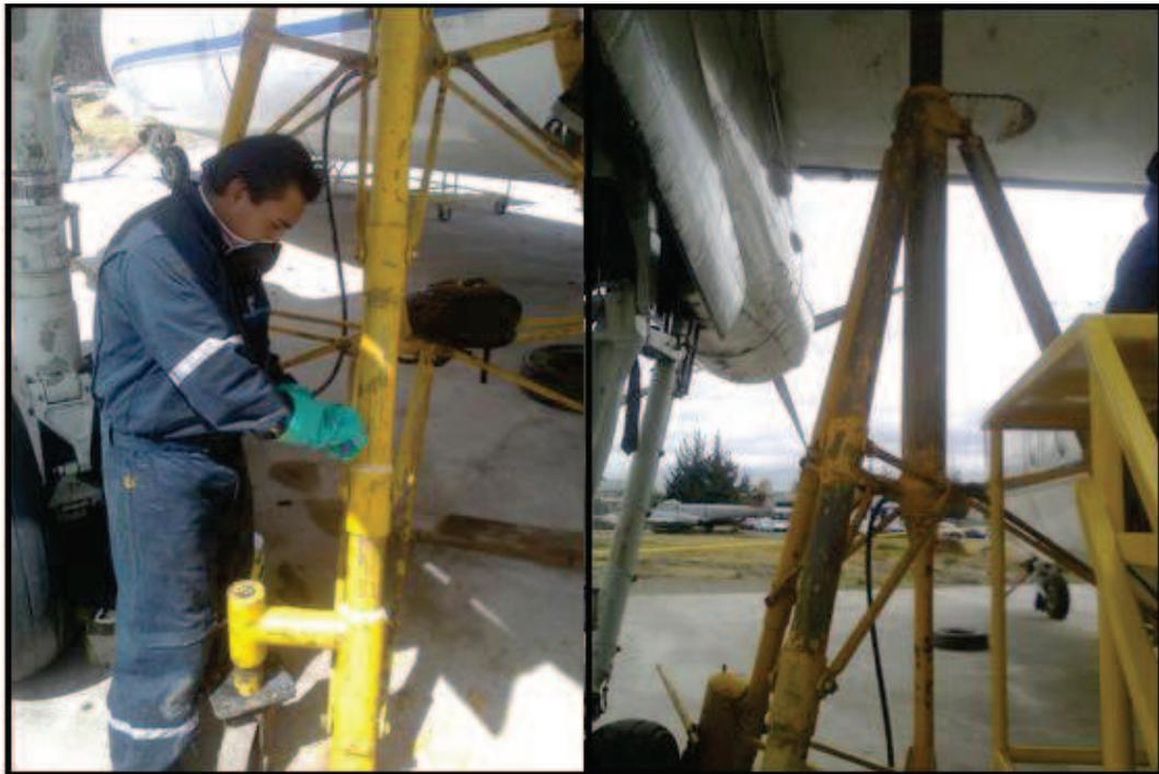
**Figura 3.14:** Retirada de la pintura de la estructura de la gata hidráulica
