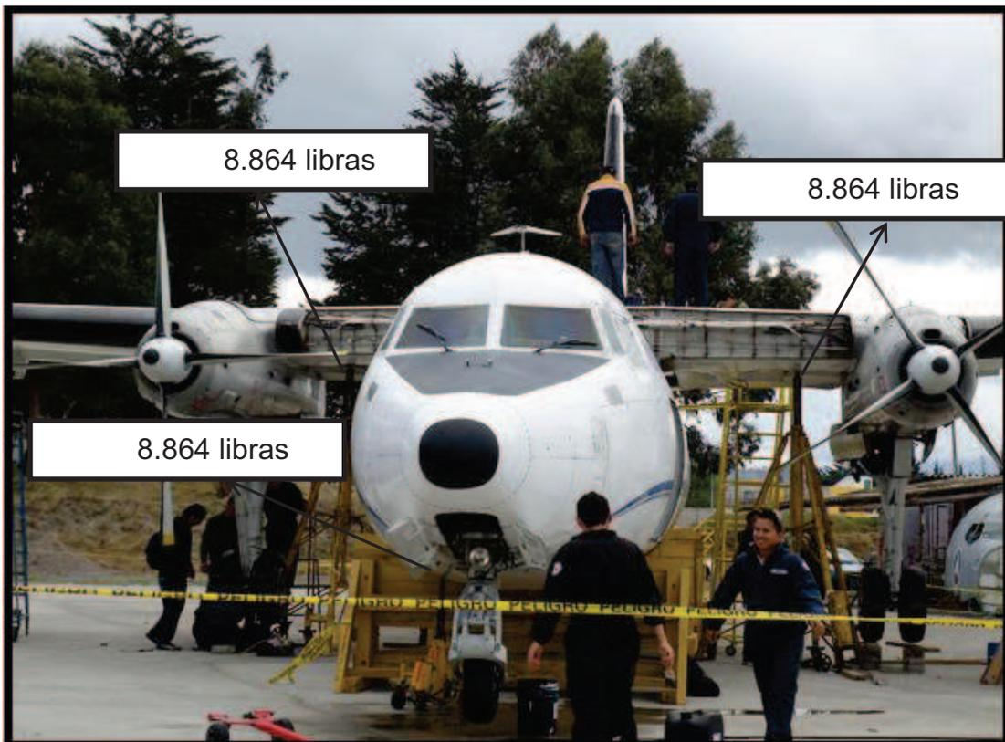
**Figura 3.16:** División del peso para los tres puntos del aeronave
