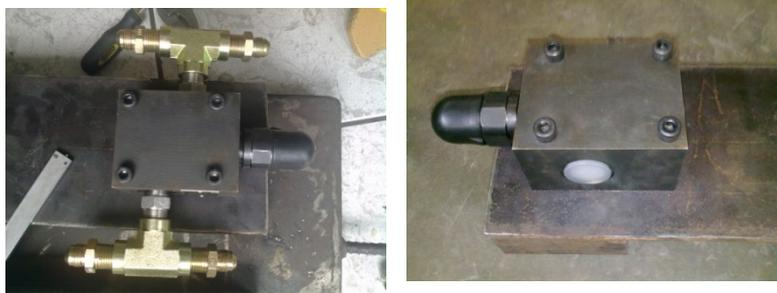
**Figura 5.19 Montaje del regulador de presión**
