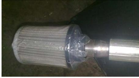
**Figura 5.21 Montaje del filtro de aceite**
