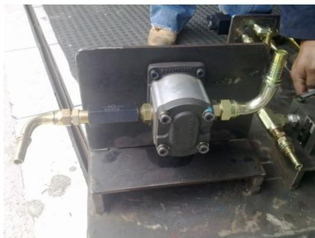
**Figura 5.18 Montaje de la válvula antirretorno y acoples**
