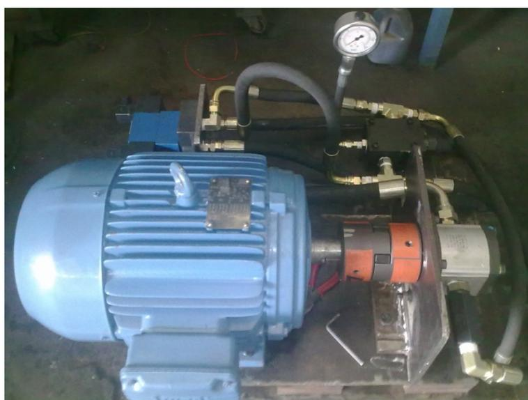
**Figura 5.23 Montaje de acoples y mangueras**
