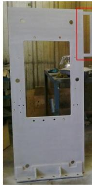
**Figura 5.13 Base del control eléctrico**
