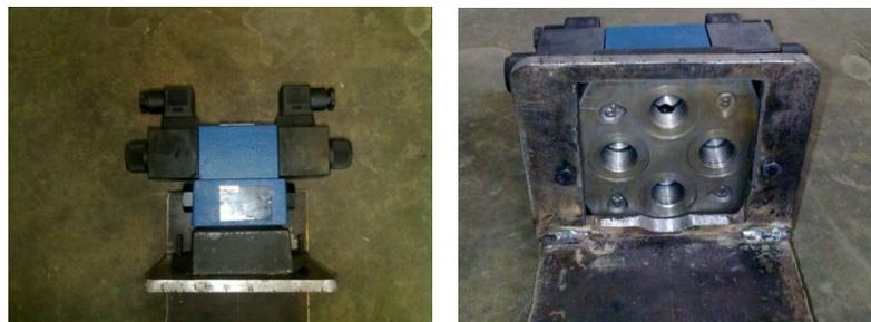
**Figura 5.20 Montaje de la válvula direccional**
