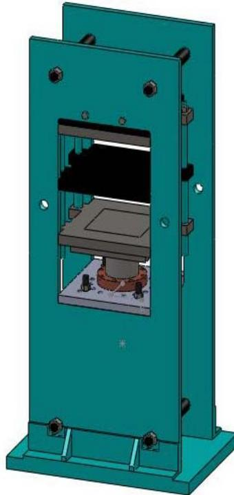
Figura 2.16 Ensamble Prensa para termomoldeado
