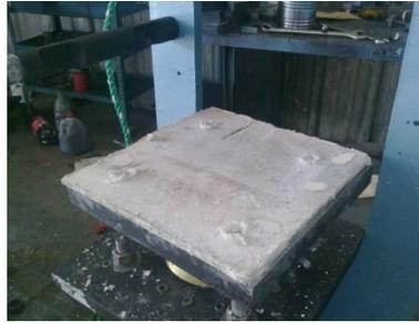
**Figura 5.15 Colocación del asbesto**
