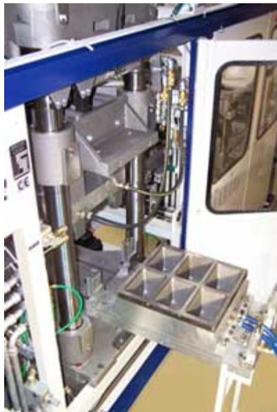
**Figura 1.32 Termoformado.**
